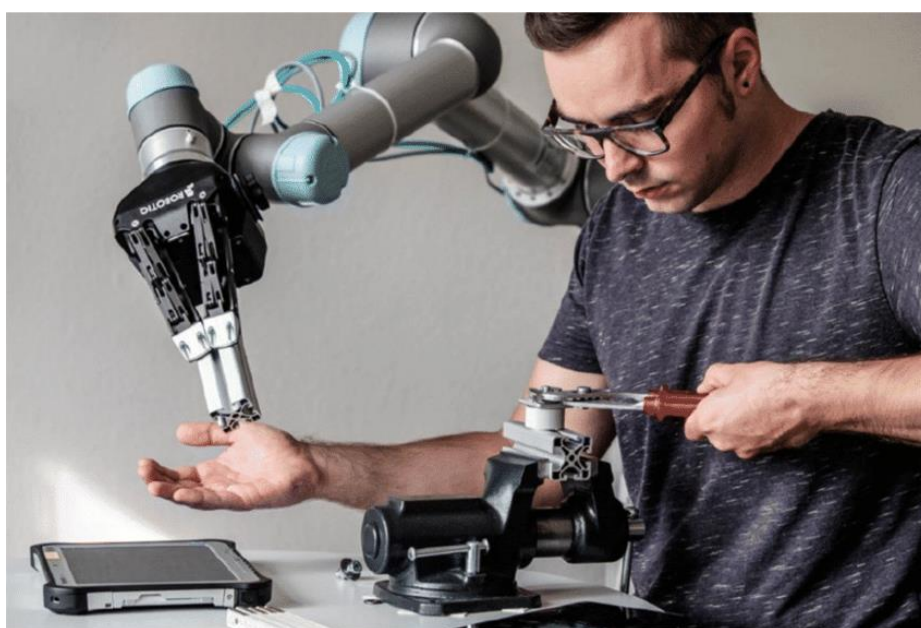
Slika 2. Kolaborativni robot pomaže čovjeku prilikom montaže [2]
