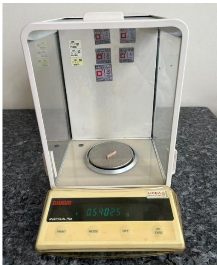
Slika 21. Određivanje mase ispitnih uzoraka na analitičkoj vagi Ohaus Analytical Plus
