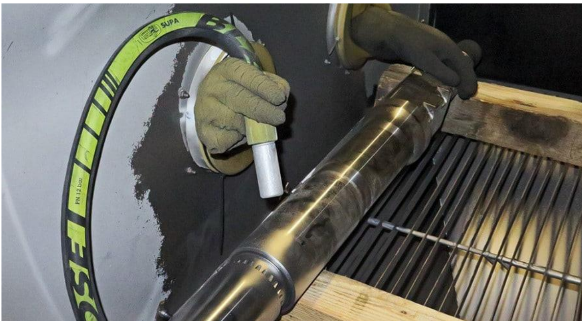
Slika 22 Ručni proces "shot peeninga" [10]
