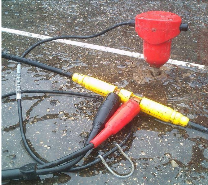
Slika 18. Vertikalni geofon niske frekvencije (4,5 Hz)
