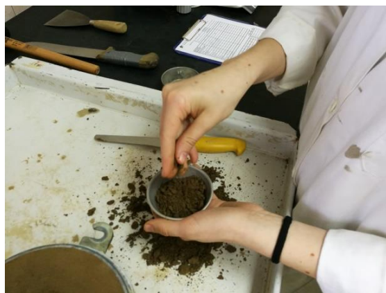
Slika 37. Usitnjavanje uzorka za određivanje vlažnosti
