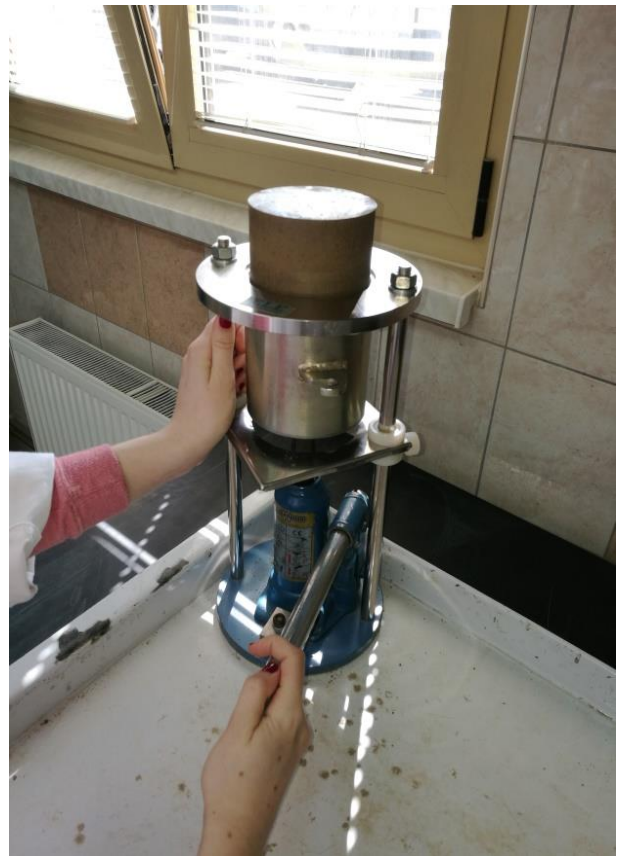
Slika 25. Vađenje zbijenog uzorka tla iz kalupa
