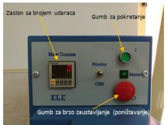
Slika 14. Kontrolna ploča na Proctor-ovom uređaju
