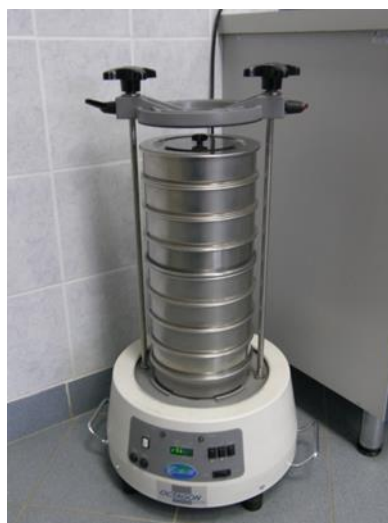
Slika 8. Niz standardnih sita pričvršćenih na tresalicu [5]
