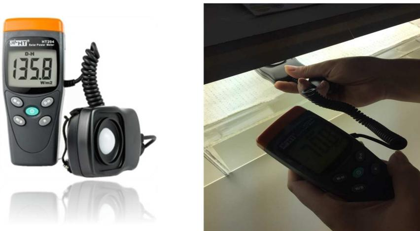
Slika 9. Prikaz solarimetra HT204 i mjerjenje intenziteta zračenja
