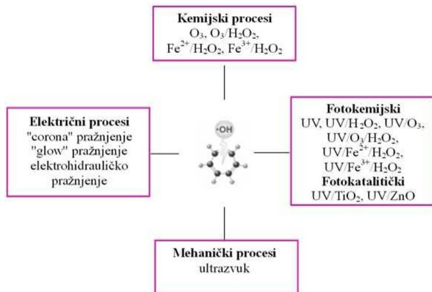
Slika 1. Shematski prikaz metoda naprednih oksidacijskih procesa
