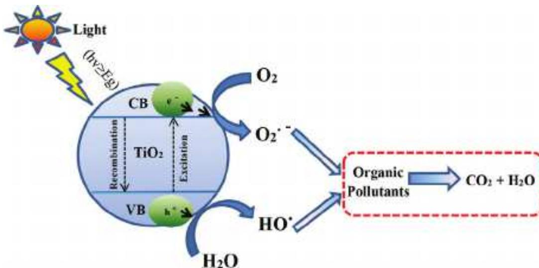
Slika 2. Mehanizam heterogene fotokatalize [28]
