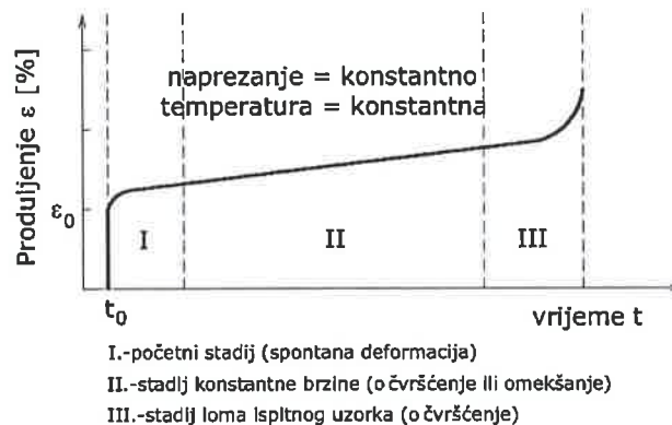
Slika 6. Dijagram deformacije plastike uslijed povećanja temperature
