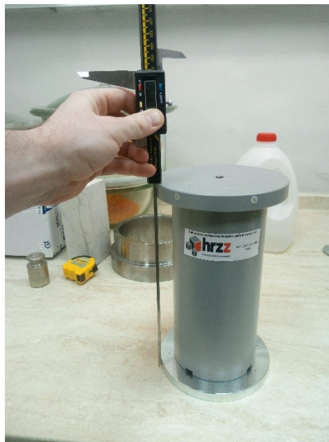
Slika 11. Određivanje visine cilindra iznad kalupa
