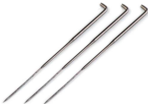
Slika 11 Igle za filcanje
