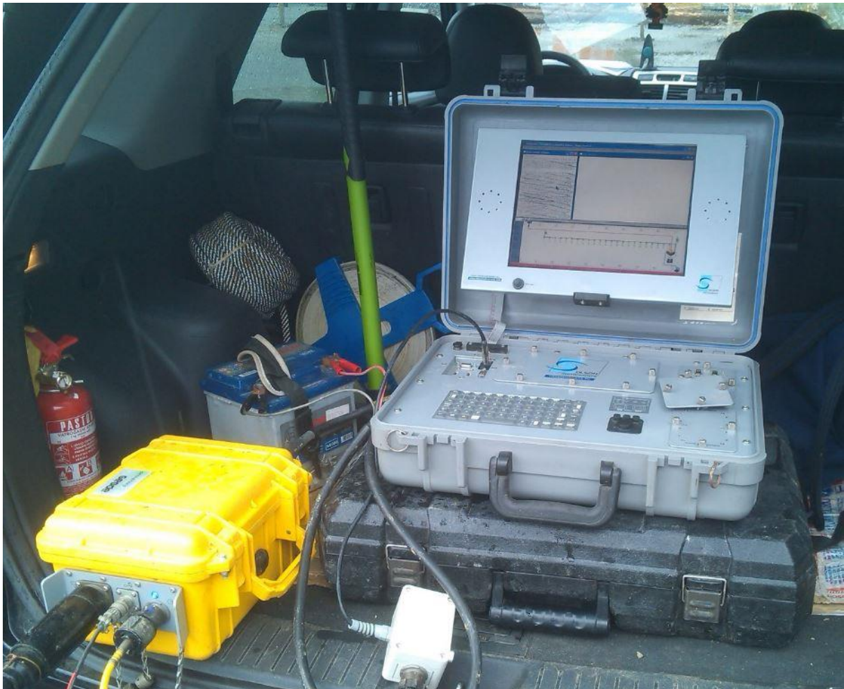
Slika 28. Seizmograf za bilježenje brzina valova
