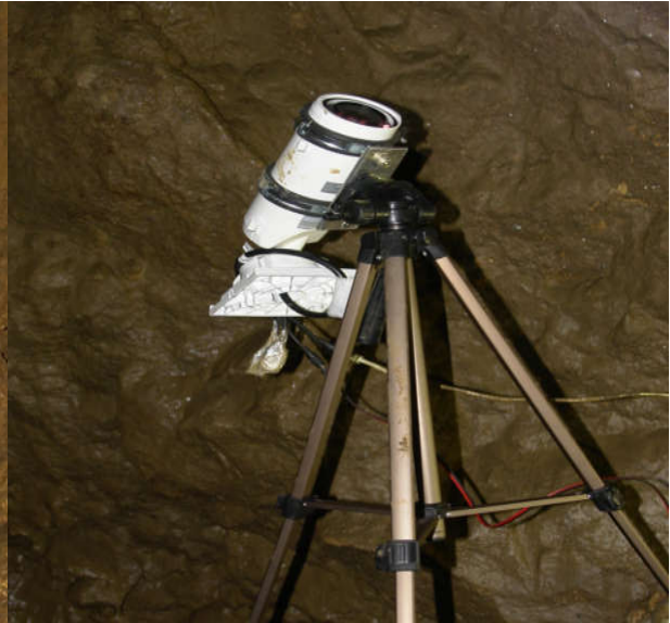
Slika 6.4 Sustav snimanja infracrvenom kamerom
