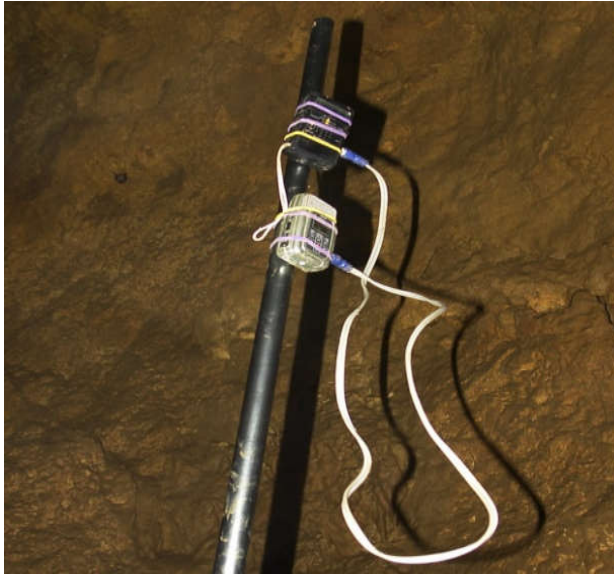
Slika 6.3 Stacionarni sustav snimanja šišmiša
