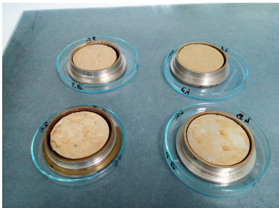
Slika 26. Uzorak nakon pokusa u edometru
