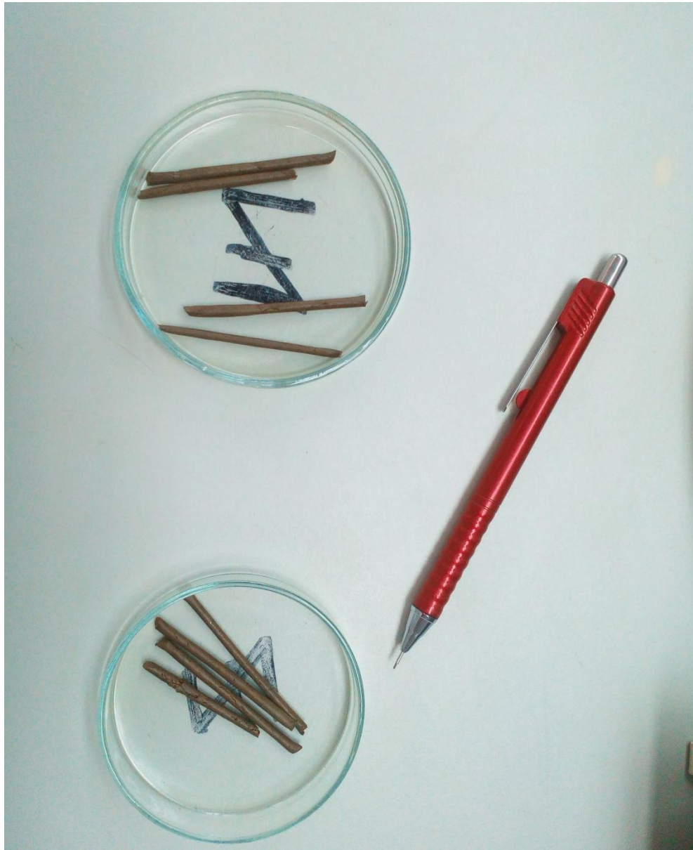
Slika 21. Valjčići za određivanje granice plastičnosti
