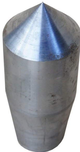
Slika 7. Šiljak DPH sonde (Szavits-Nossan, 2006)
