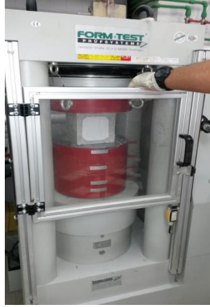
Slika 9. Ispitivanje tlačne čvrstoće betona
