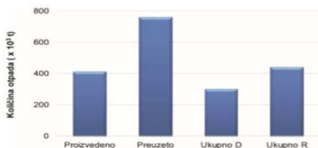
Slika 12. Usporedba prijavljenih proizvedenih i preuzetih ukupnih količina građevnog otpada te udjela D i R postupaka [20]
