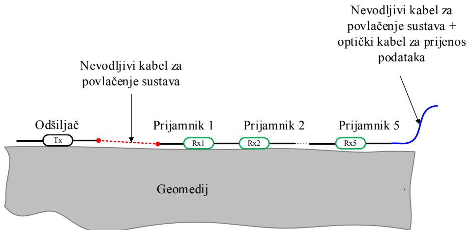
Slika 3. Shematski prikaz sustava OhmMapper TR5, Geometrics Inc. za terensko mjerjenje (Yamashita et al., 2004).
