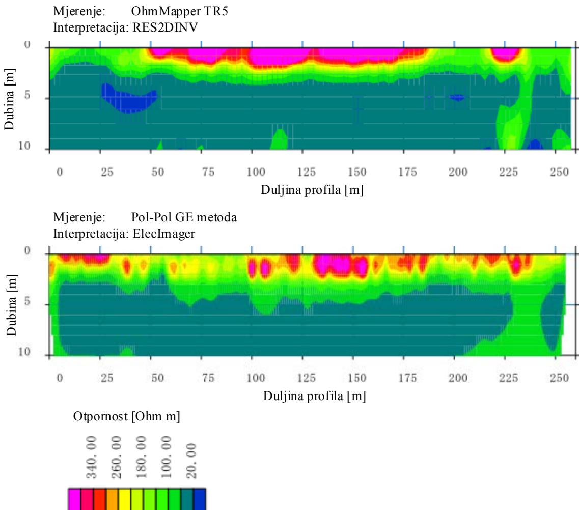
Slika 5. Usporedba mjerena i interpretacije i) OhmMapper TR5 (Geometrics Inc.) i RES2DINV (gornja slika), ii) pol-pol geoelektrična metoda otpornosti i ElecImager (OYO Corp.) duž istog profila u koherentnom tlu (glinovita sredina) do dubine 10 m (Yamashita et al., 2004).
