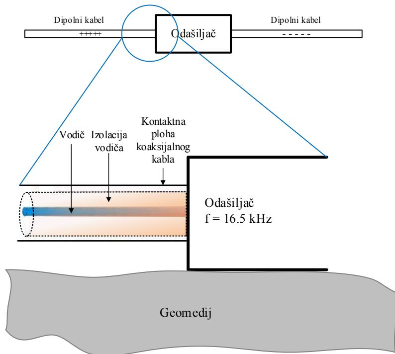
Slika 4. Shematski prikaz konstrukcije dipolnog kabla (Yamashita et al., 2004).
