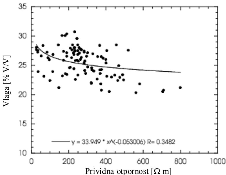
Slika 8. Aproksimacija podataka prividne otpornosti mjerene OhmMapperom i sadržaja vlage mjerelim TDR metodom. Udaljenost odašiljač-prijamnik je bila 2 m, a mjerena TDR sustavom su zahvatila 70 cm dubine. (Walker and Houser, 2000). Mjerena su provedena u pjeskovitom, odnosno pjeskovito-prašinasto-glinovitom tlu (engl. sandy loam).
