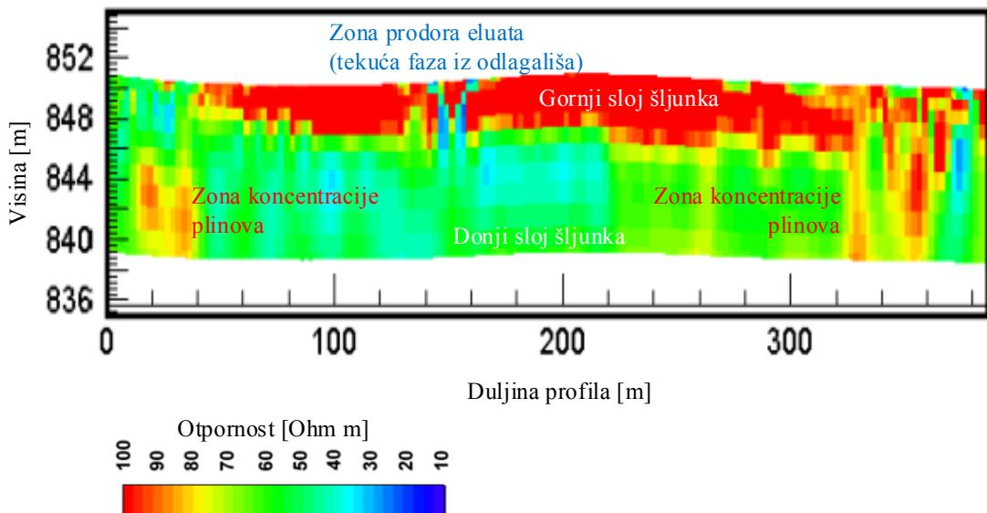
Slika 9. Profil otpornosti kroz slojeve šljunka u neposrednoj blizini odlagališta. Mapiranje je izvedeno OhmMapperom TR5. Veće otpornosti u donjem sloju šljunka ukazuju na koncentraciju plinova iz odlagališta u porama. Male otpornosti u gornjem sloju su indikativne za zone procjeđivanja tekuće faze iz odlagališta u gornje naslage šljunka. (Lucius et al. 2008).
