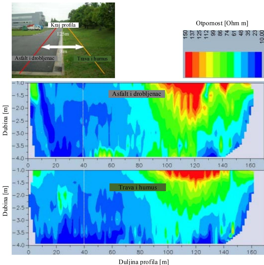
Slika 6. Usporedba mjeranja i interpretacije: OhmMapper TR5 (Geometrics Inc.) i RES2DINV duž paralelnih profila u istoj geoelektričnoj sredini s različitim površinskim slojevima (asfalt i drobljenac - gornja slika, u odnosu na humus – donja slika) (Yamashita et al., 2004). Dubina zahvata je bila 4 m.
