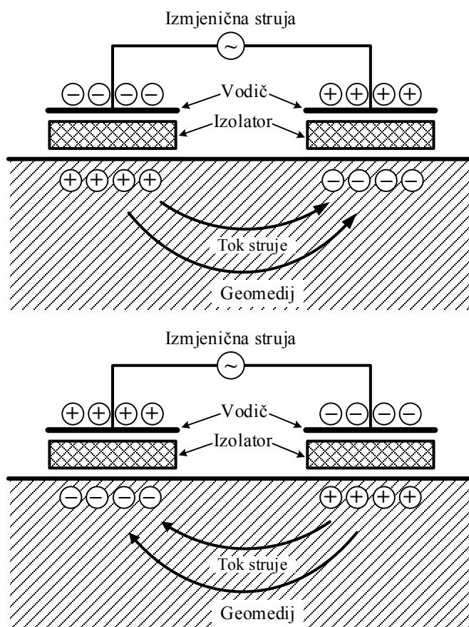
Slika 1. Konceptualni model kapacitivnog mjerjenja otpornosti (engl. capacitively-coupled resistivity, CCR) (Yamasita et al., 2004).
