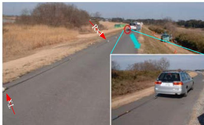
Mjerenje: OhmMapper TR5
