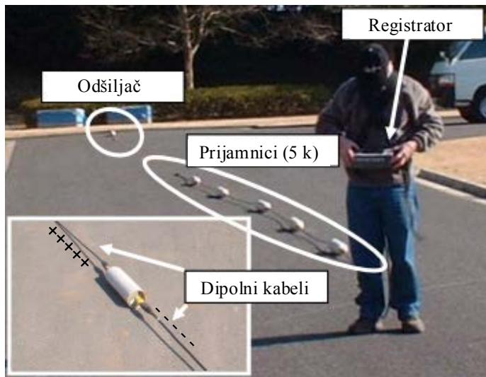
Slika 2. Izgled sustava za mapiranje vodljivosti s jednim odašiljačem i pet prijamnika (kanala): OhmMapper TR5, Geometrics Inc. (Yamashita et al., 2004).
