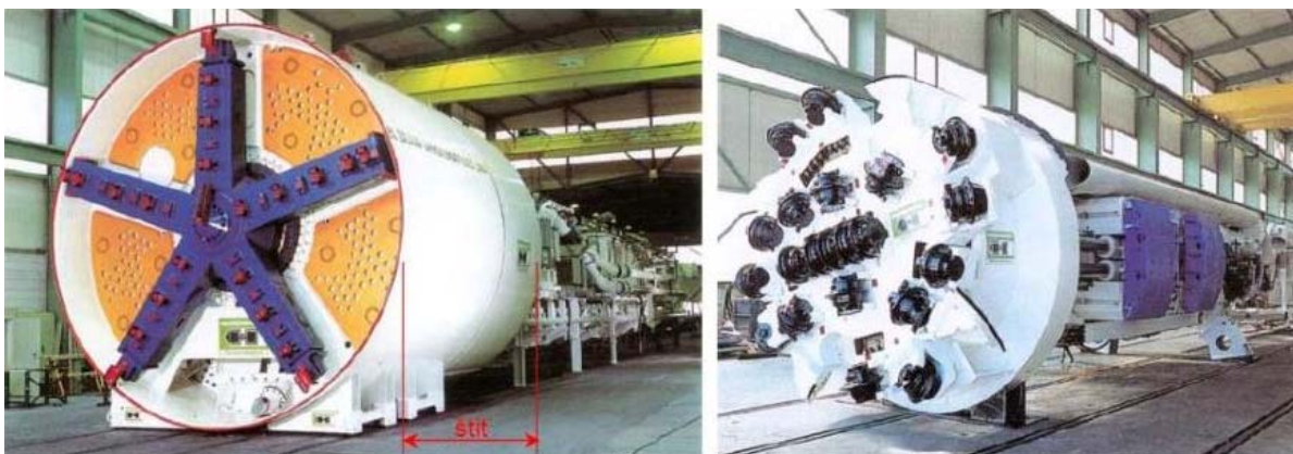
Slika 7.2 Stroj sa i bez štita
