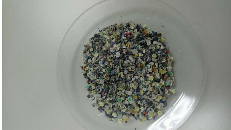
Slika 14: NMF tiskane pločice prije vakuumske pirolize
