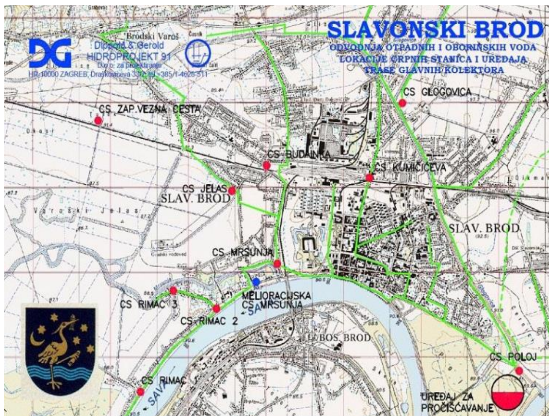
Slika 13. Karta sustava odvodnje grada Slavenskog Broda (Šperac i sur. 2012)
