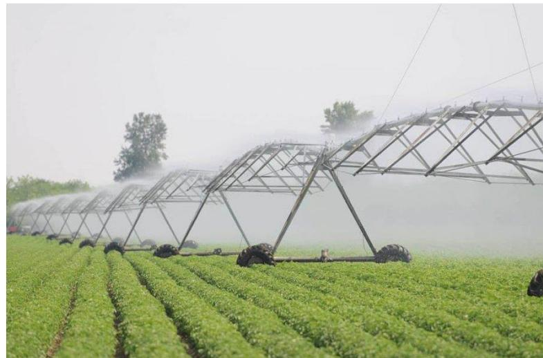
Slika 9. Navodnjavanje graška linijskim pokretnim sustavom navodnjavanja [8]
