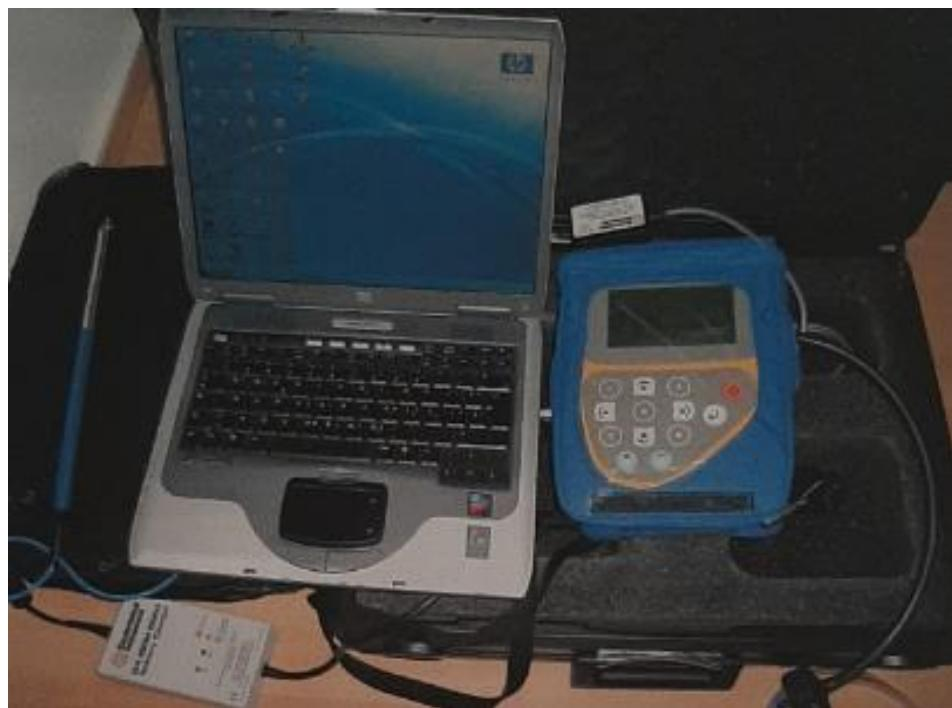
Slika 6. Instrument za mjerjenje plinova – GA 2000 – ANSYCO [16]
