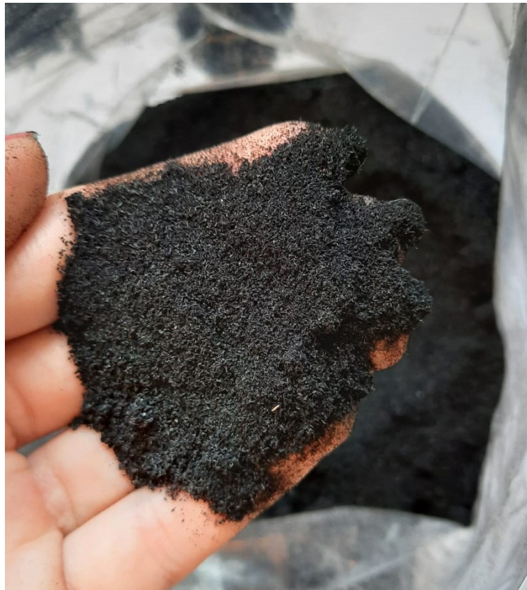
Slika 11. Gumeni granulat veličine 0,0 – 0,5 mm
