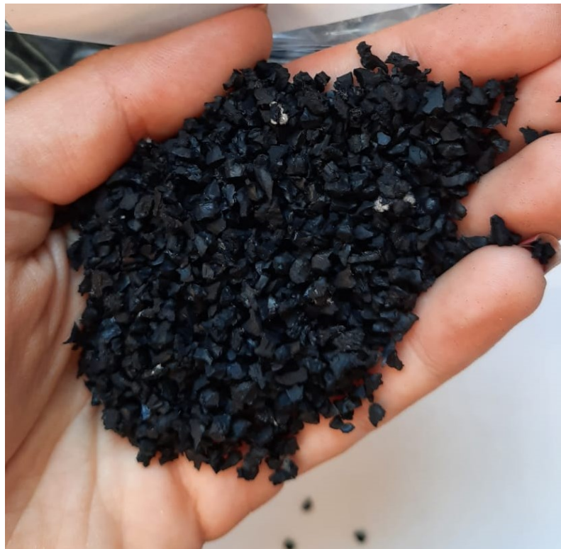
Slika 13. Gumeni granulat veličine 2,0 – 3,5 mm
