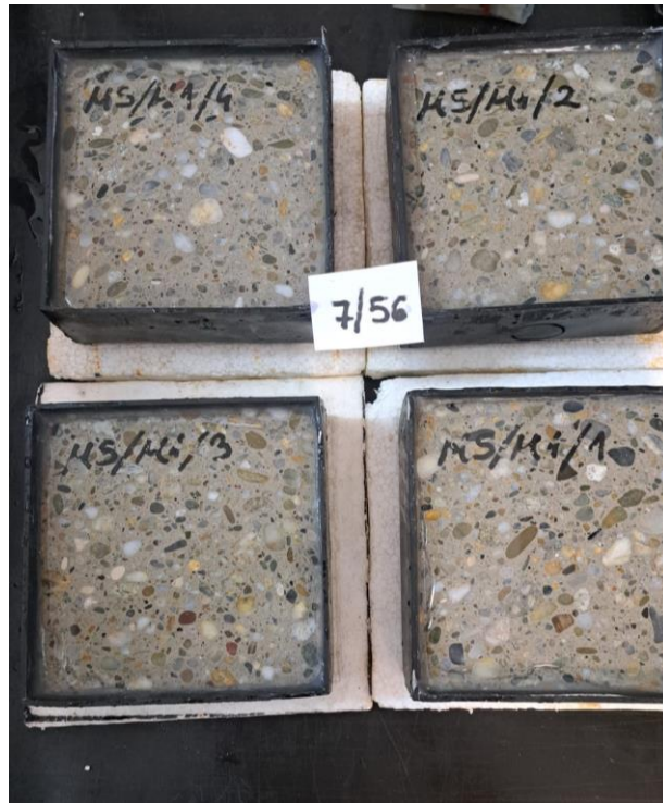
Slika 24: Ljuštenje mase kod mješavine M1 nakon 7. ciklusa
