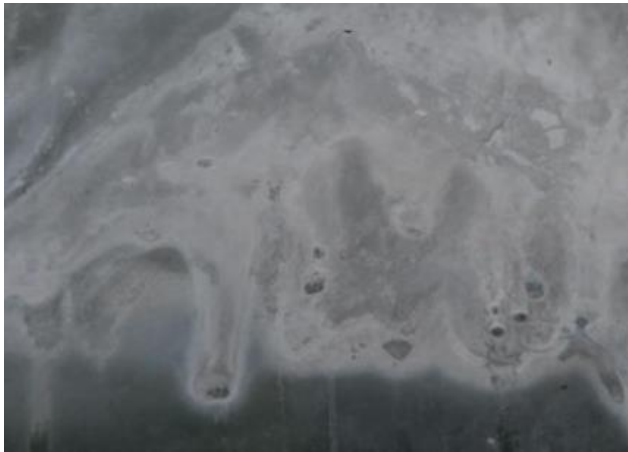
Slika 20 Prikaz korodiranog stakla [25]
