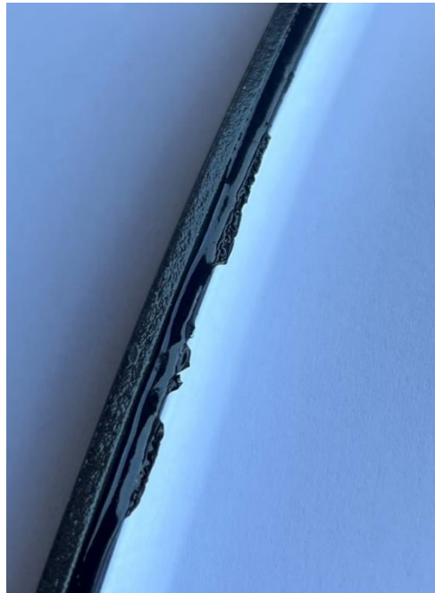
Slika 32 Prikaz butila nanešenog na aluminijski profil
