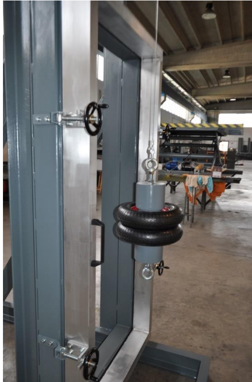
Slika 42 Oprema za ispitivanje klatnom [38]
