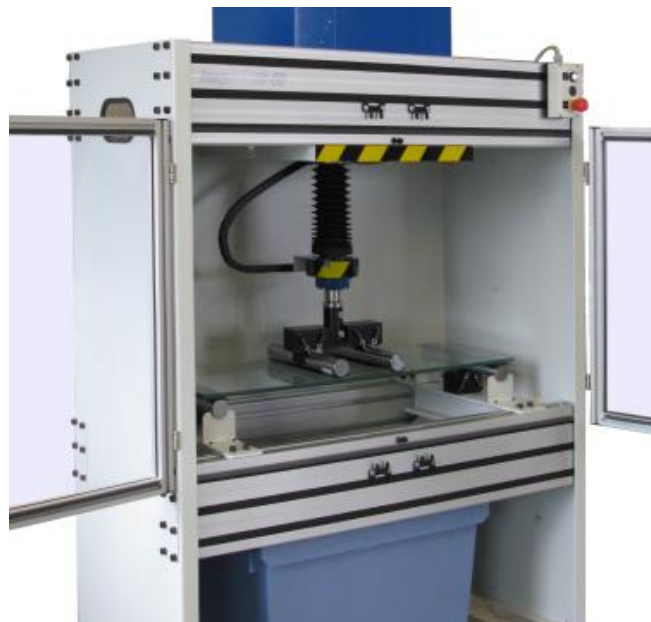
Slika 19 Laboratorijsko ispitivanje čvrstoće stakla [28]
