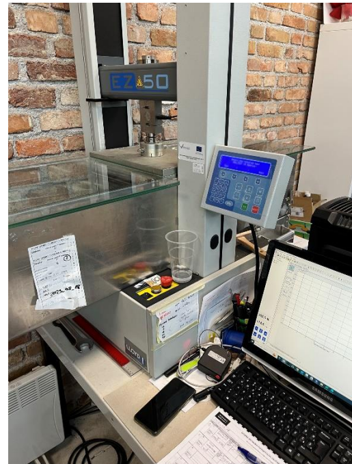
Slika 18 Preša za ispitivanje čvrstoće stakla
