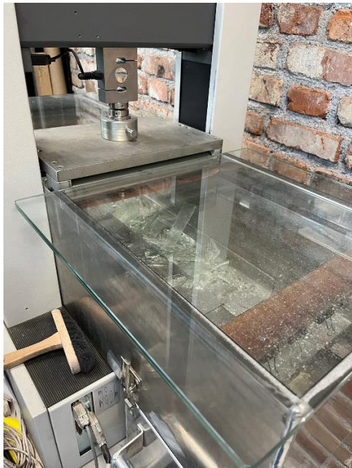
Slika 17 Preša za ispitivanje čvrstoće stakla
