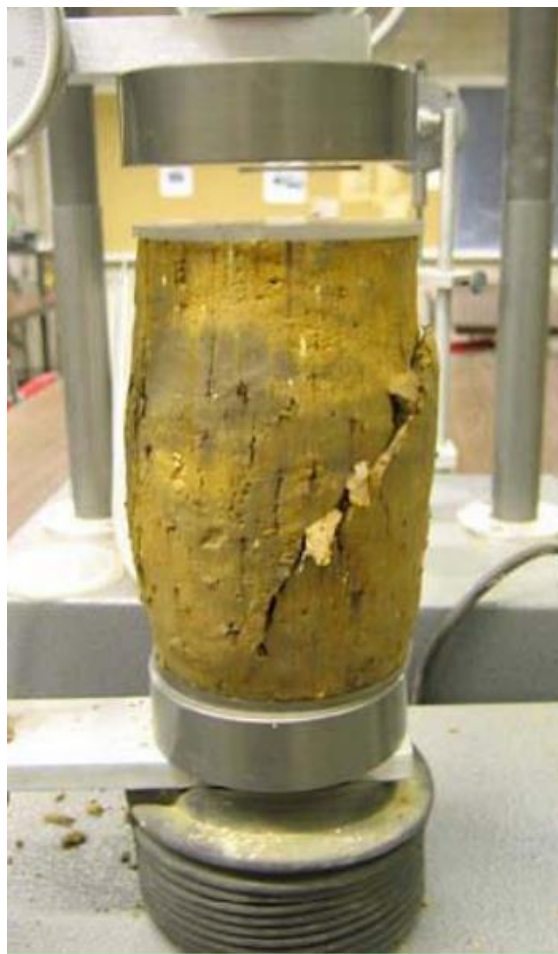
Slika 13 Ispitivanje jednoosne čvrstoće [15]
