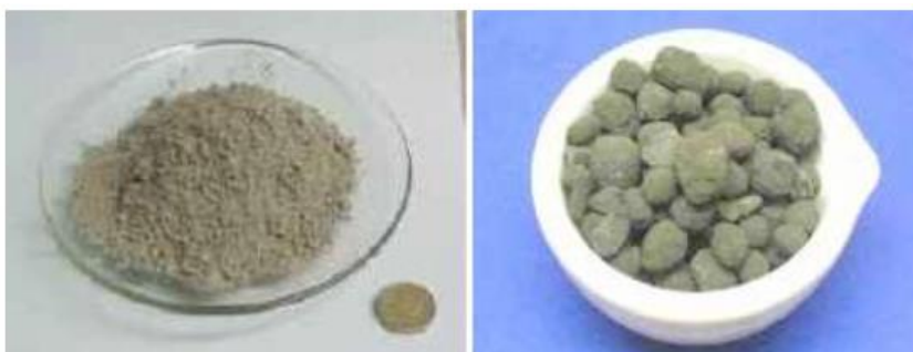
Slika 2. Razlika između cementa (lijevo) i klinkera (desno) [3].
