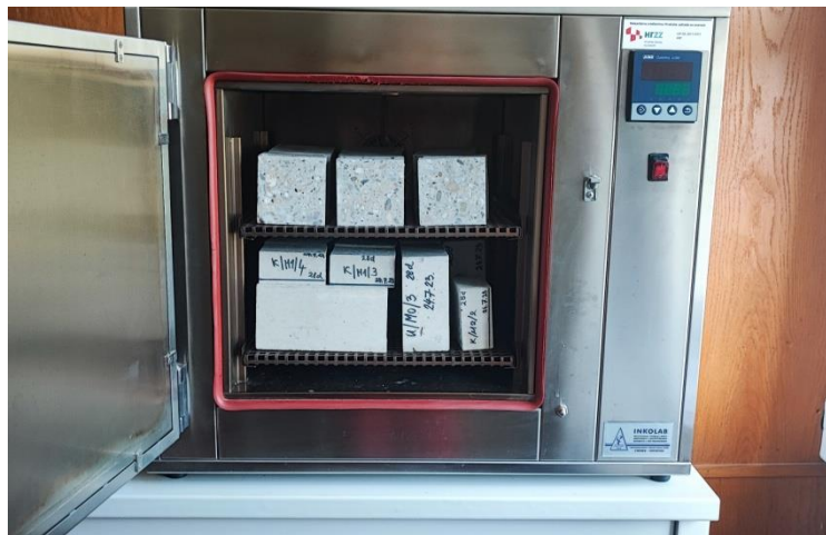
Slika 16: Uzorci za kapilarno upijanje nakon sušenja u sušioniku
