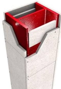
Slika 40 Ploče kao zaštita od požara a) pričvršćenje ploča na čelični stup; b) požarna otpornost
