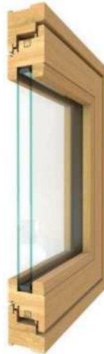
Slika 17.: Puni profil drvenog prozorskog okvira (Izvor: [27])
