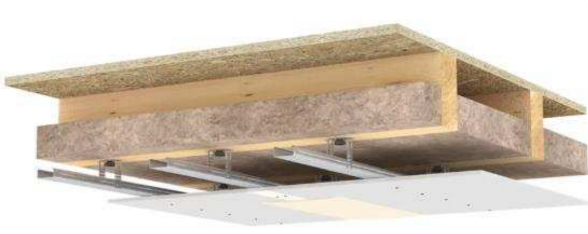
Slika 14: Podgled s gipskartonskim pločama na metalnim nosačima
