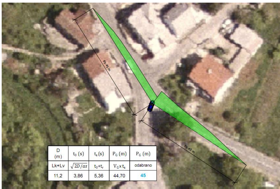
Slika 36. Raskrižje Drenova sa proračunom duljine preglednosti
