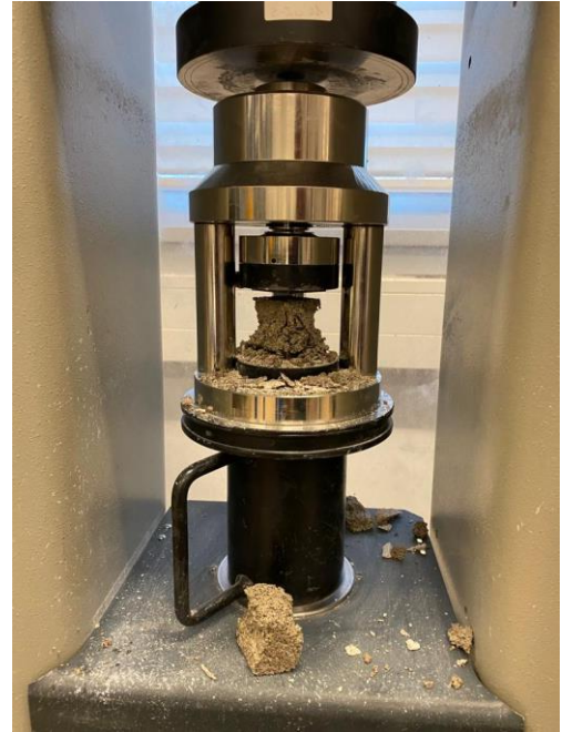
Slika 31. Oblik sloma uzorka, nakon spitivanja na tlak
