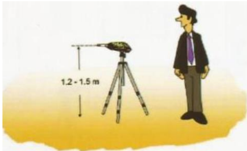
Slika 4: Visinski položaj zvukomjera [4]
