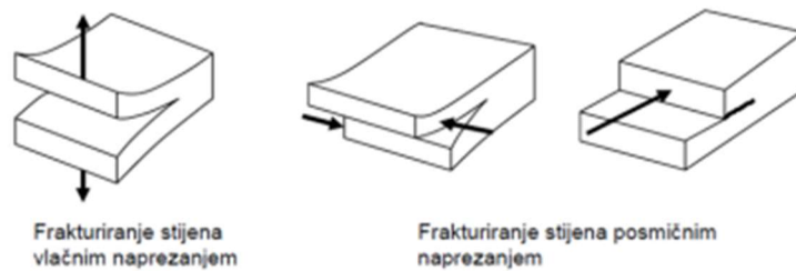
Slika 2: Načini nastajanja diskontinuiteta [3]
