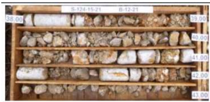
Slika 23: Uzorci ispitivane jezgre u sanduku sa oznakama bušotine i dubine [38]
