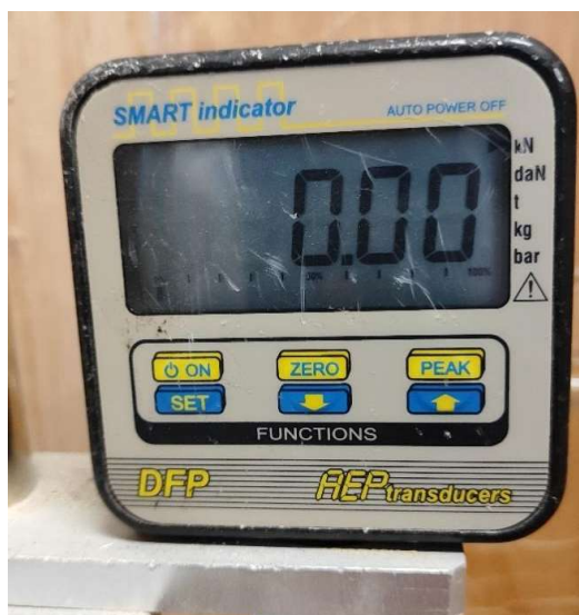
Slika 14: Mjerilo sile na PLT uređaju
