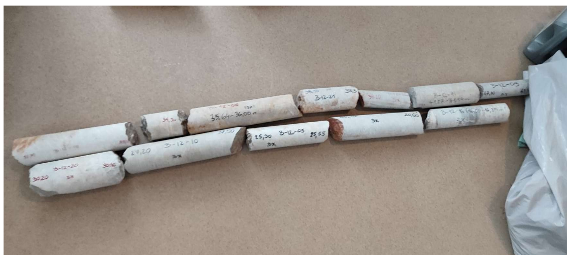
Slika 24: Uzorci intaktne stijene korišteni pri izradi diplomskog rada, prije njihove pripreme za ispitivanje
