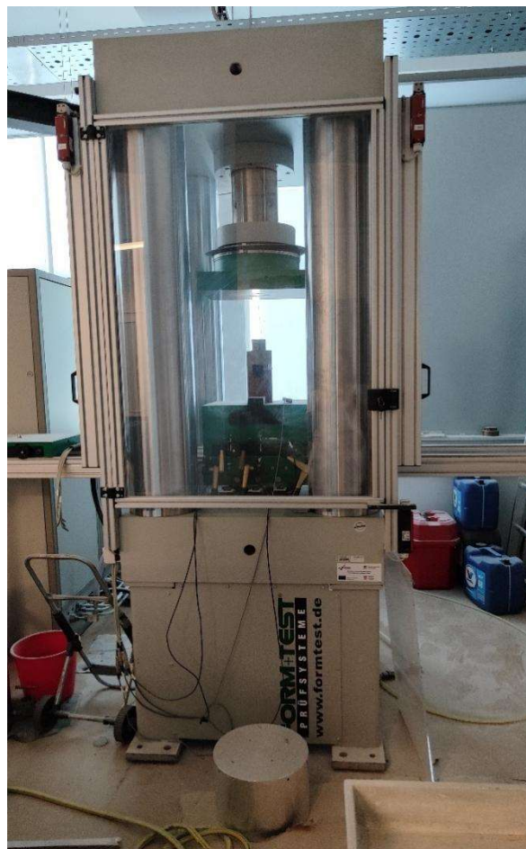
Slika 7: FORM+TESTS ALPHA 1-2000s preša za stijene u Laboratoriju za geotehniku Građevinskog fakulteta u Rijeci
