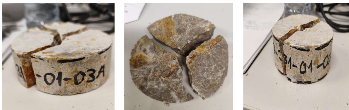
Slika 28: Uzorci ispitivani aksijalnim testom nakon loma
