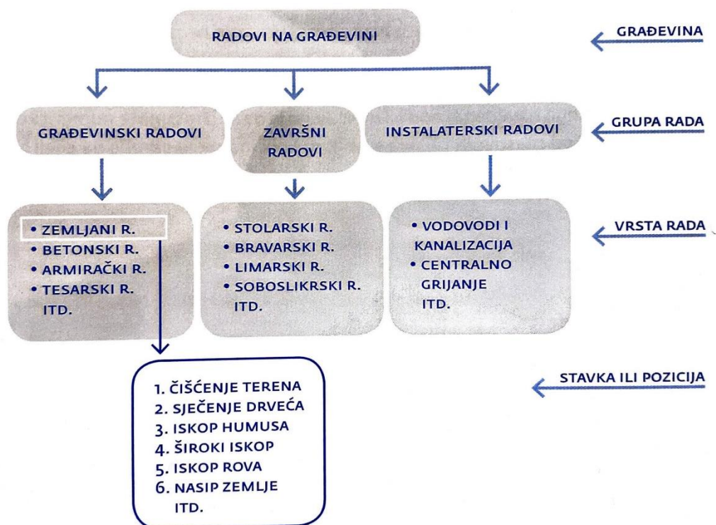
Slika 8. Prikaz podjele radova na građevini [1]
