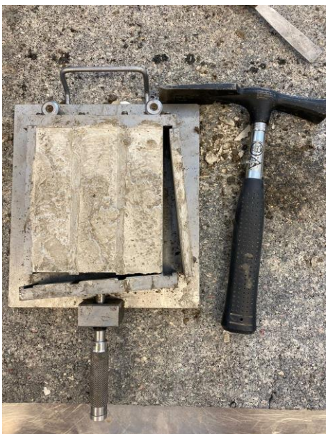
Slika 20. Odvajanje kalupa od cementnih prizmi
