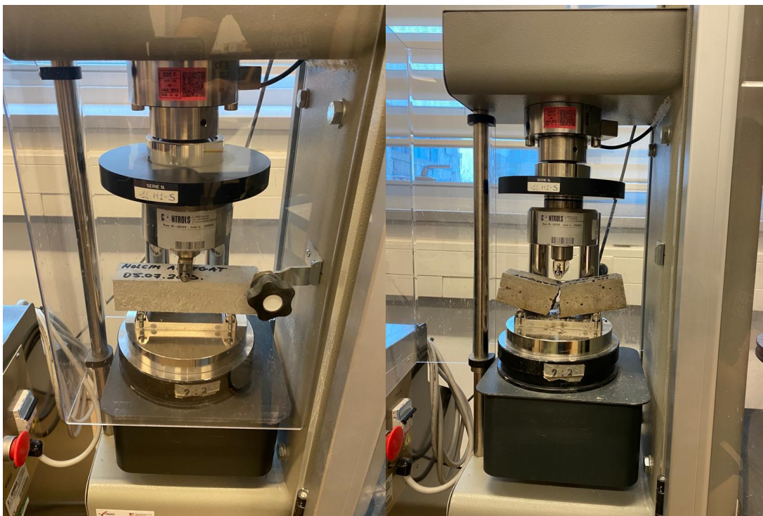
Slika 25. Ispitivanje vlačne čvrstoće savijanjem
