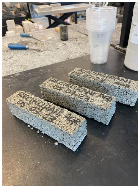
Slika 22. Prizme s recikliranim agregatom
