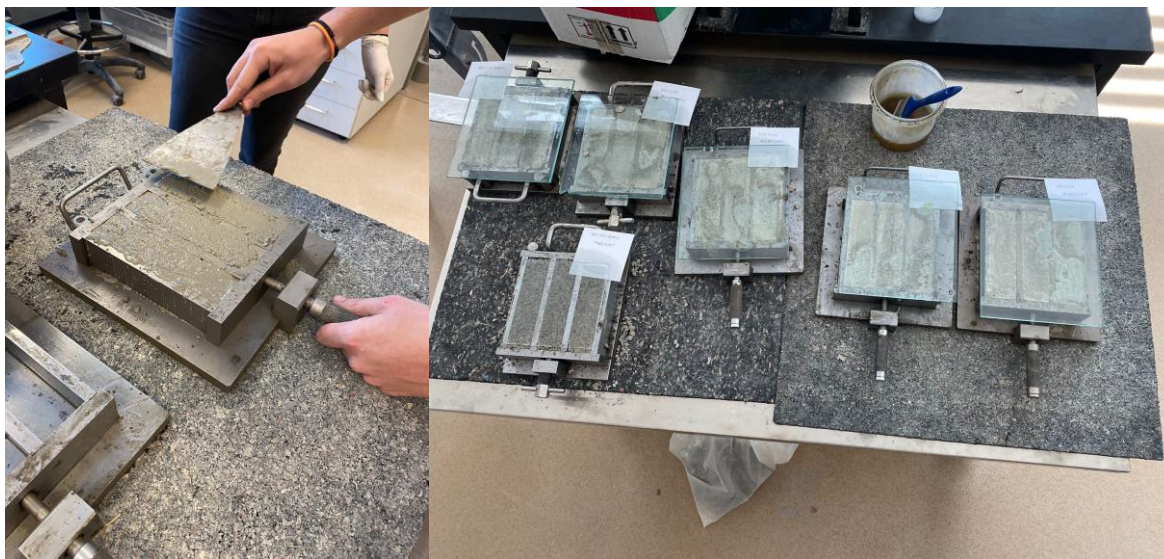
Slika 19. Cementni mort u kalupima
