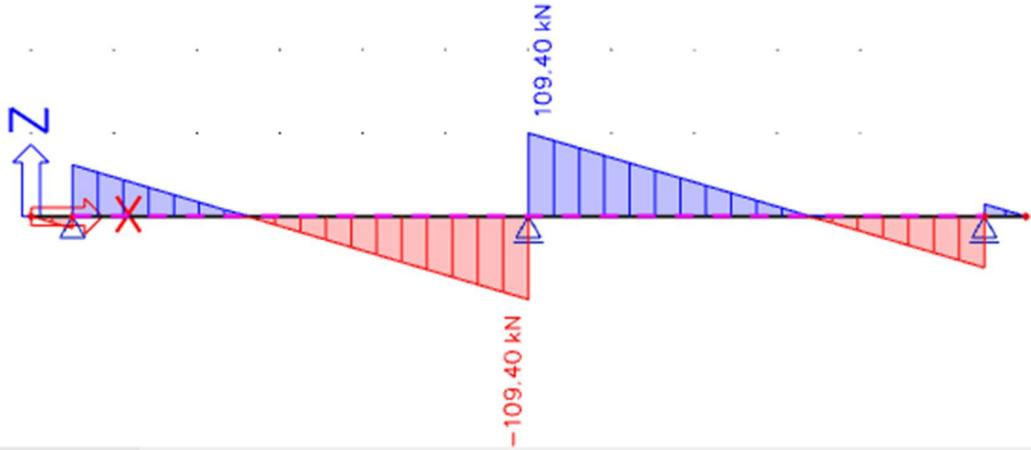
**Poprečna sila**  $V_{Ed}=109.40 \text{ kN}$
