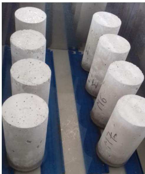
Slika 47 Primjer ispitivanja vodoupojnosti
