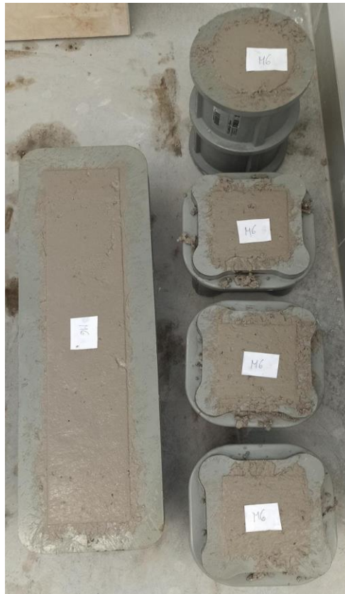
Slika 39 Ukalupljeni uzorci M6
