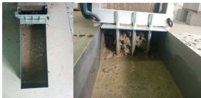
Slika 7.25: Ispitivanje L-posudom – mješavina L3
