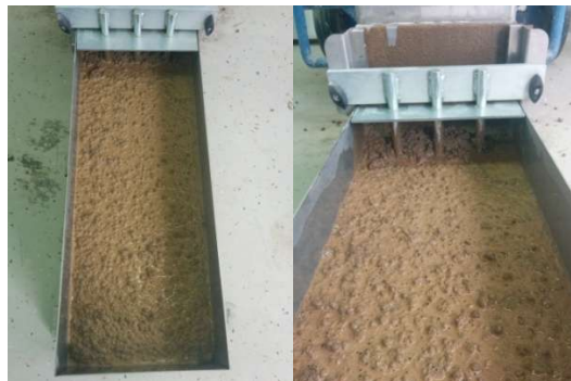
Slika 7.23: Ispitivanje L-posudom – mješavina L1
