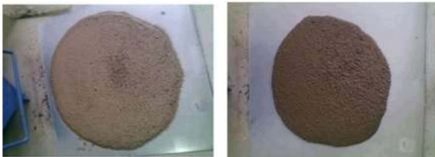
Slika 5.13: Rasprostiranje slijeganjem: a) Mješavina SCLC2- segregacija i odvajanje vode (slika lijevo); b) Mješavina SCLC3- stabilna mješavina ali ljepljiva (slika desno)[18]
