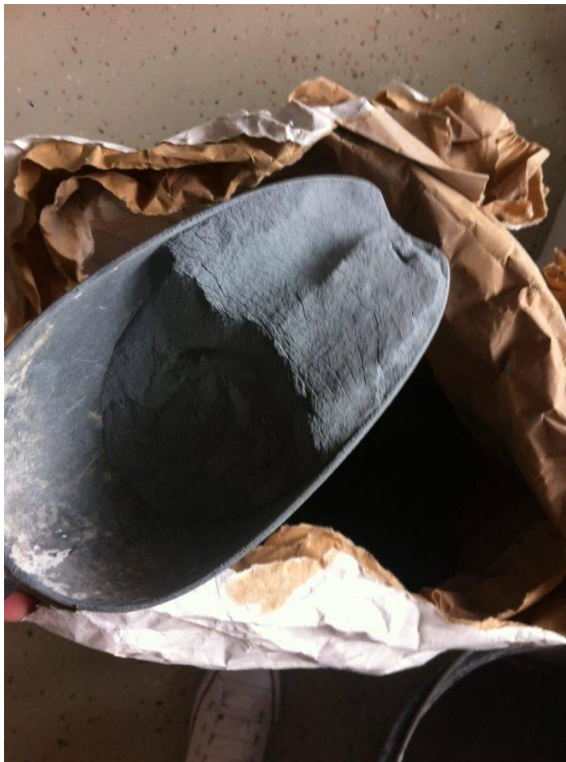
Slika 4.3 Silicijska prašina koja se koristila pri izradi poroznih mješavina
