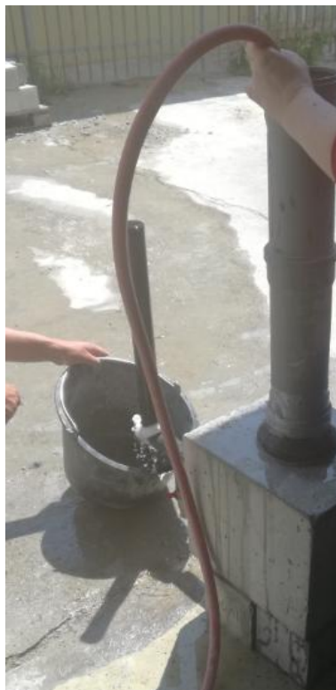
Slika 4.10 Ispitivanje propusnosti metodom stalne razine stupca vode
