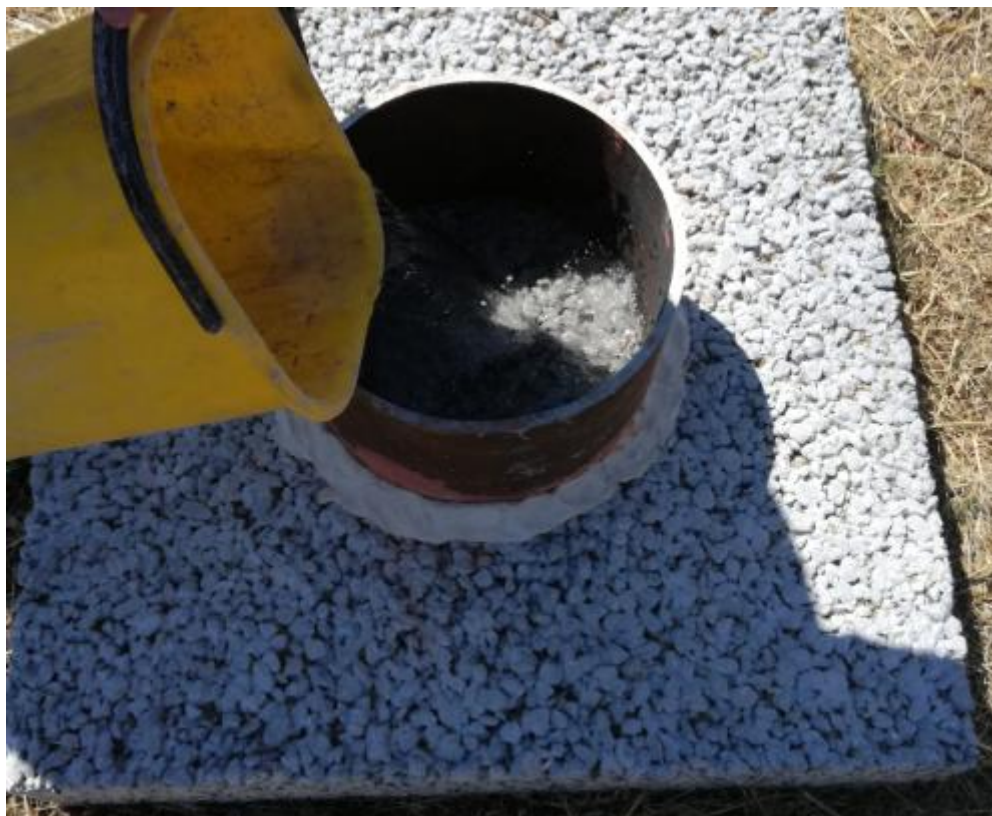
Slika 4.19 Mjerenje brzine infiltracije [26]
