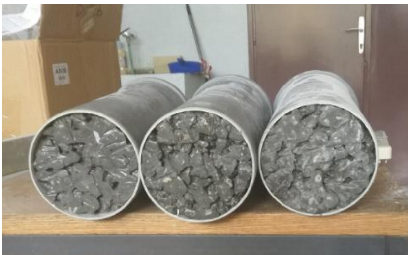
Slika 5.21 Presjeci mješavina P 6 , P 5 i P 4 .
