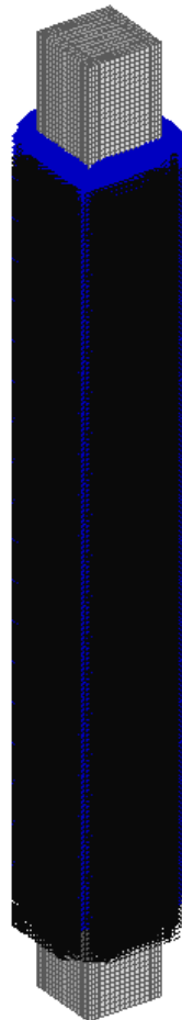
Slika 4.5: Prikaz ukupnog temperaturnog opterećenja (u čvorove konačnih elemenata i vanjske površine konačnih elemenata)
