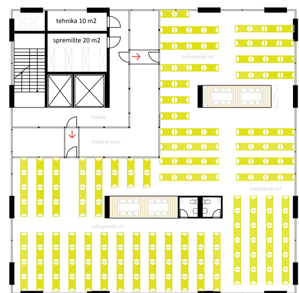
tlocrt karakteristične etaže / zajednički hidropski vrt 450 m<sup>2</sup>
