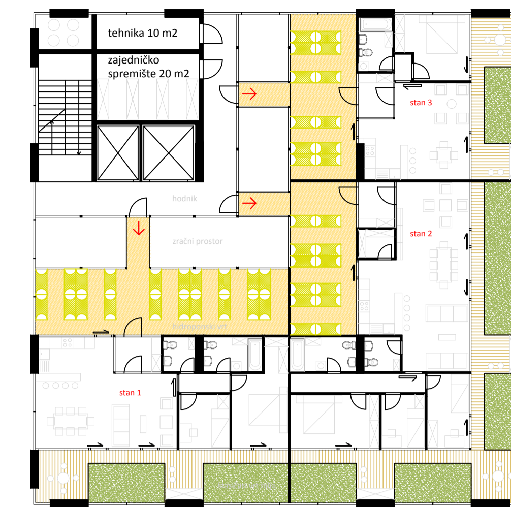
tlocrt karakteristične etaže / stanovanje + hidroponski vrt
