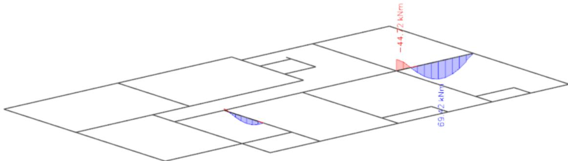
Slika 6.17. Moment savijanja  $M_{Ed,y}$  (kNm) za GSU1
