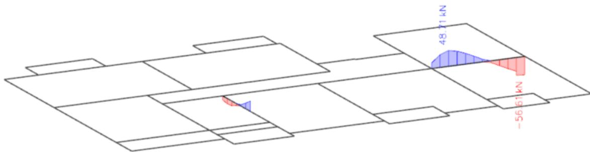
Slika 6.4. Poprečne sile  $V_{Ed,z}$  (kN) za GSN
