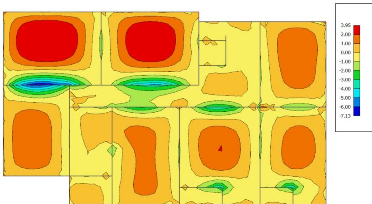
Slika 5.8. Armatura u ploči  $A_{s,y-y}$  ( $\text{cm}^2/\text{m}$ ) za GSN
