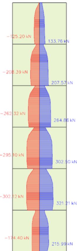
Slika 11.3. Poprečne sile (kN)
