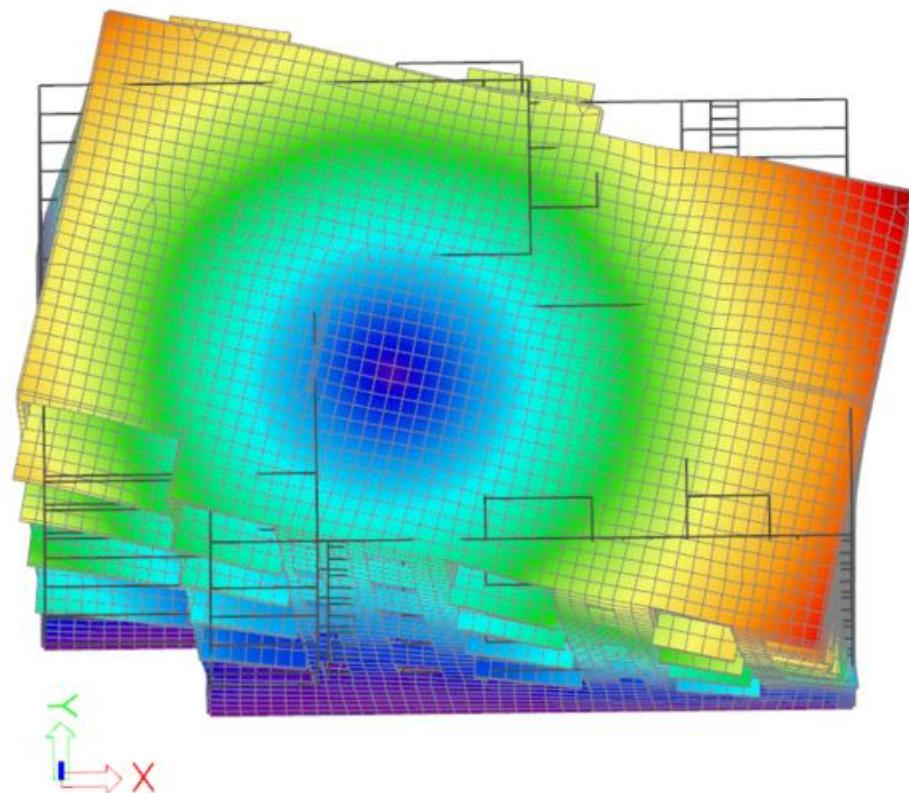
Slika 10.5. Grafički prikaz trećeg vlastitog vektora (uvrtanje oko osi z)
