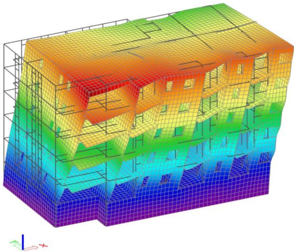
Slika 10.3. Grafički prikaz prvog vlastitog vektora (translacija u smjeru osi x)
