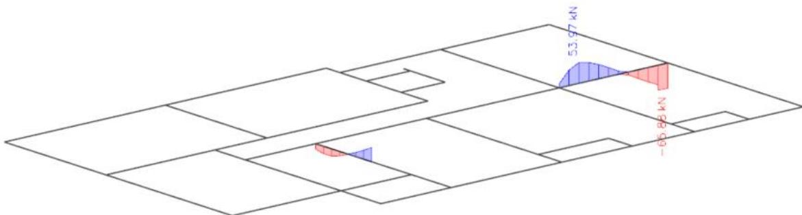
Slika 7.4. Poprečne sile  $V_{Ed,z}$  (kN) za GSN
