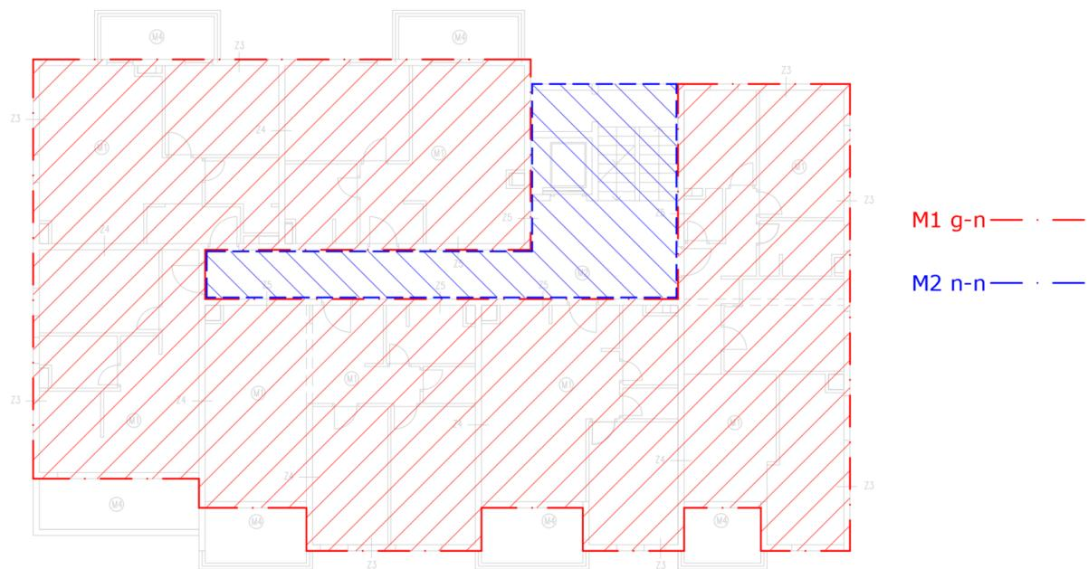
Slika 13.4. Prikaz građevnih dijelova – ploče međukatnih konstrukcija
