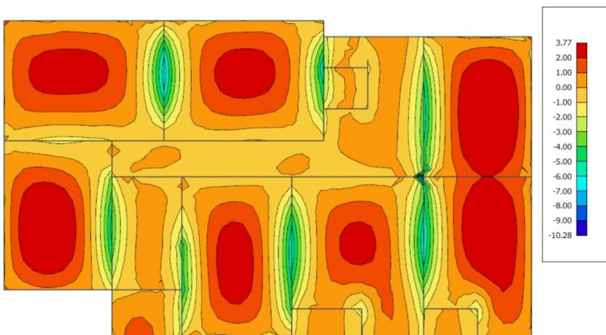
Slika 5.7. Armatura u ploči  $A_{s,x-x}$  ( $\text{cm}^2/\text{m}$ ) za GSN
