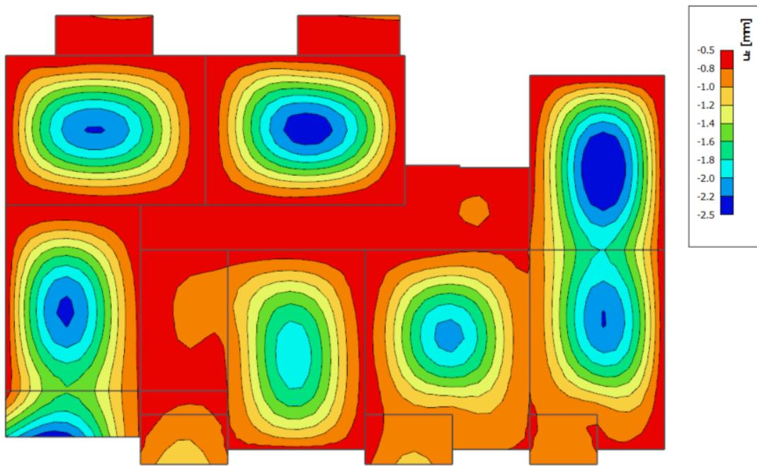
Slika 4.10. Progib ploče (mm) za kombinaciju GSU1
