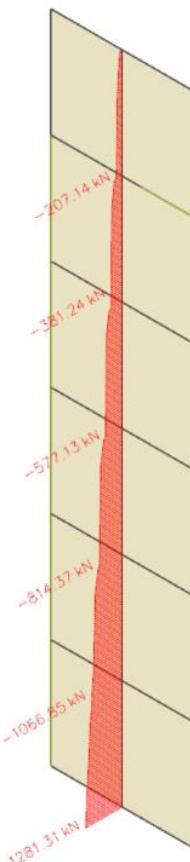
Slika 11.4. Uzdužne sile (kN)
