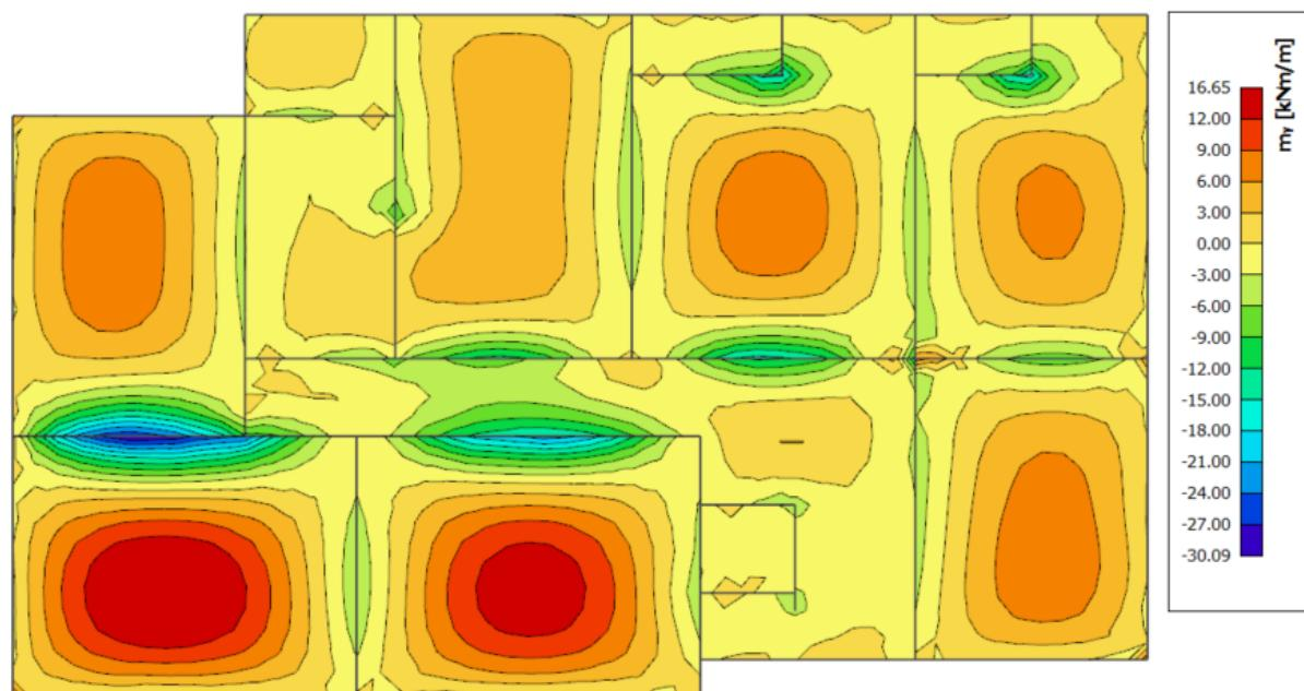
Slika 5.13. Moment savijanja  $M_{Ed,y}$  (kNm/m) za GSU1
