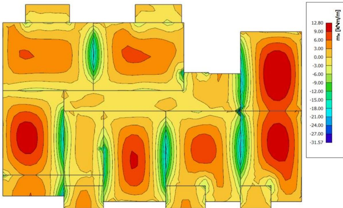
Slika 4.12. Moment savijanja  $M_{Ed,x}$  (kNm/m) za GSU1
