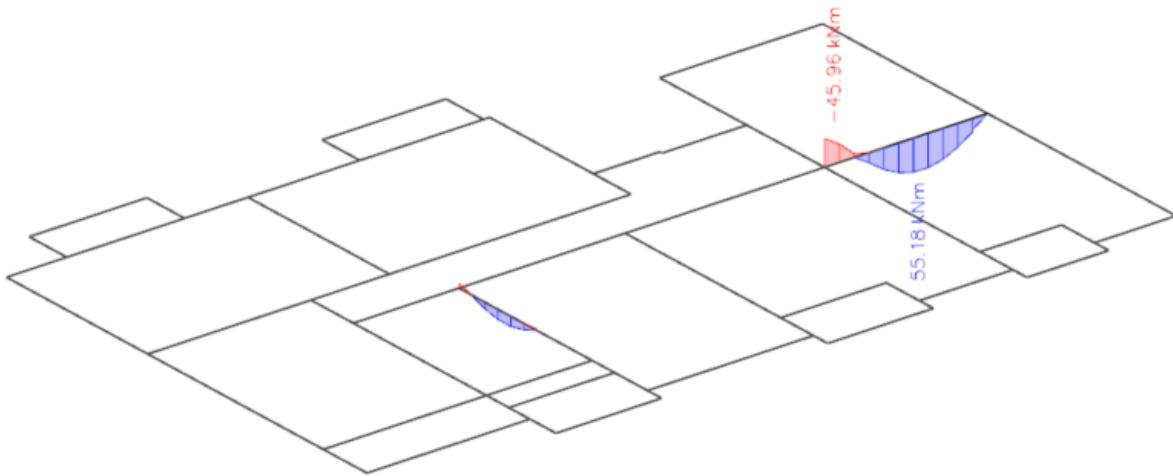
Slika 6.17. Moment savijanja  $M_{Ed,y}$  (kNm) za GSU1
