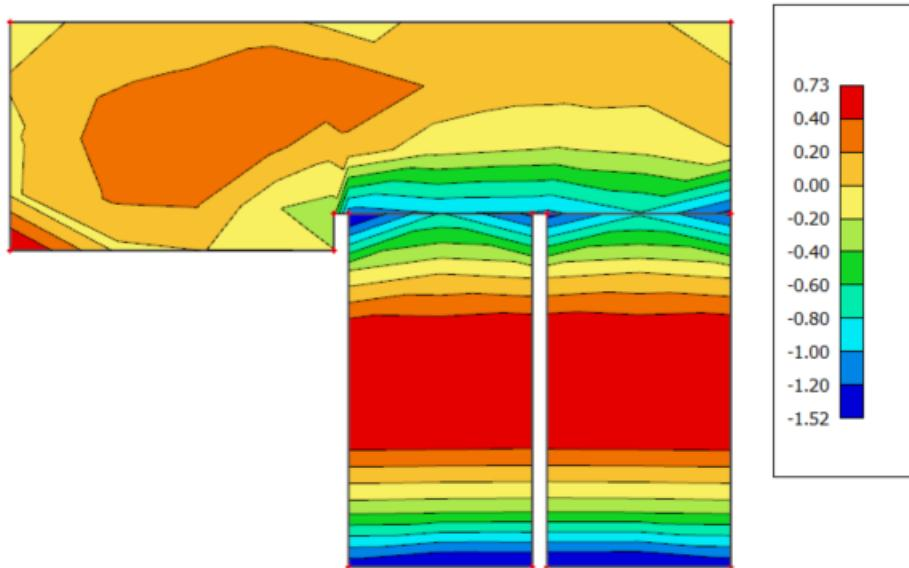
Slika 8.6. Armatura u stubištu  $A_{s,y-y}$  ( $\text{cm}^2/\text{m}$ ) za GSN
