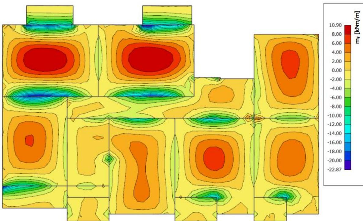
Slika 4.13. Moment savijanja  $M_{Ed,y}$  (kNm/m) za GSU1
