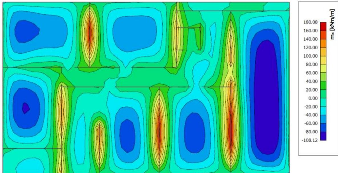
Slika 9.10. Moment savijanja  $M_{Ed,x}$  (kNm) za GSU1
