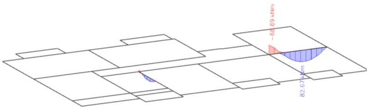
Slika 6.3. Moment savijanja  $M_{Ed,y}$  (kNm) za GSN
