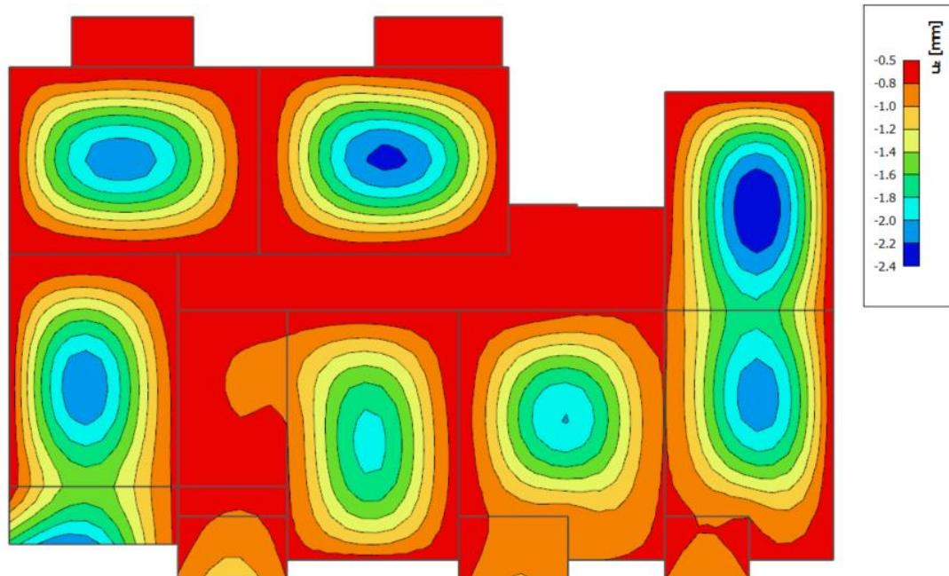
Slika 4.11. Progib ploče (mm) za kombinaciju GSU2
