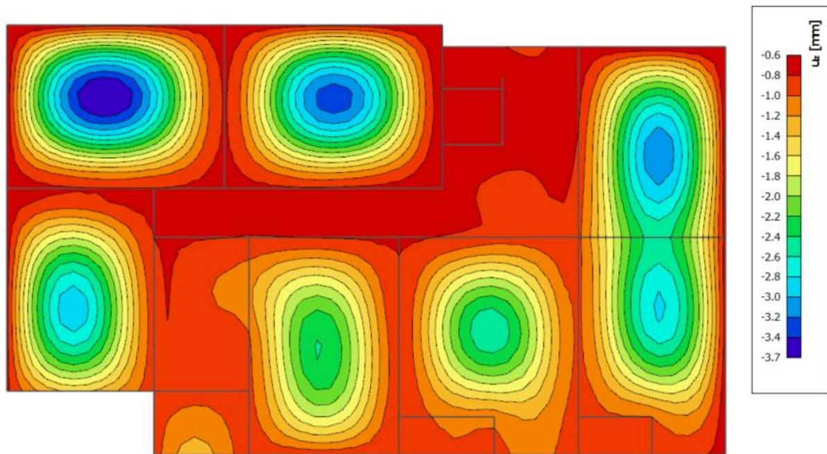
Slika 5.10. Progib ploče (mm) za kombinaciju GSU1
