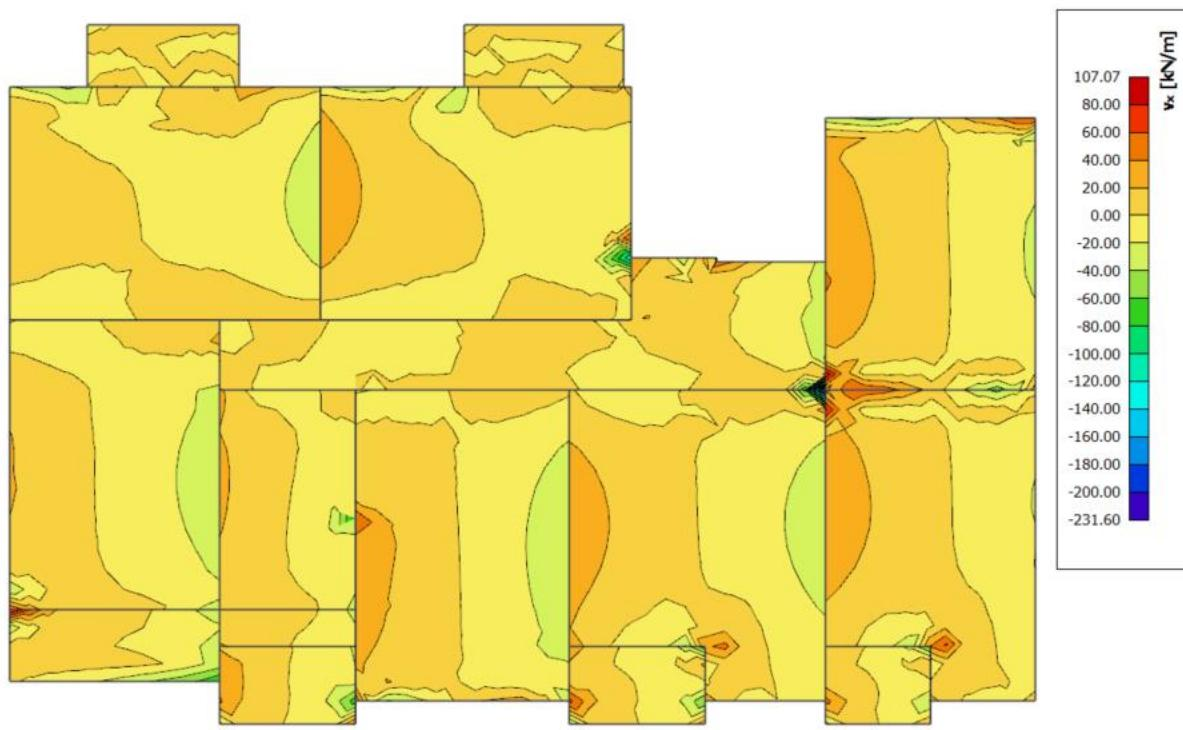
Slika 4.5. Poprečne sile  $V_{Ed,x}$  (kN/m) za GSN
