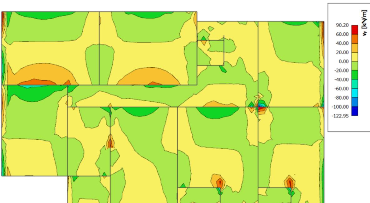
Slika 5.6. Poprečne sile  $V_{Ed,y}$  (kN/m) za GSN
