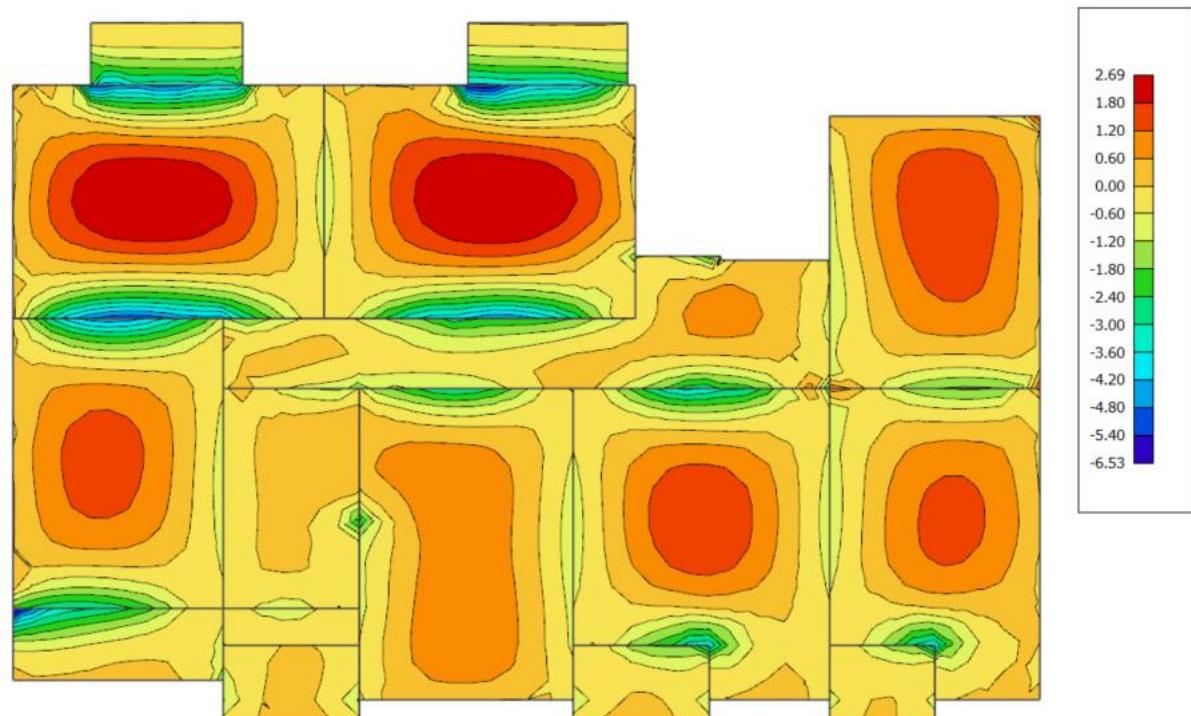
Slika 4.8. Armatura u ploči  $A_{s,y-y}$  ( $\text{cm}^2/\text{m}$ ) za GSN
