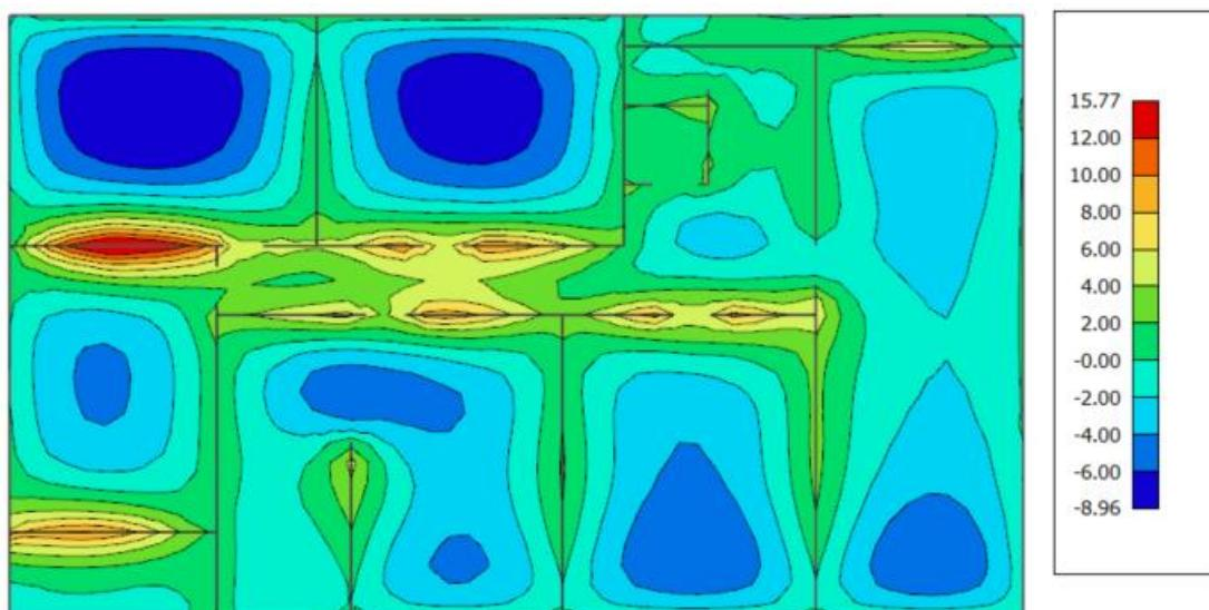
Slika 9.8. Armatura u ploči  $A_{s,y-y}$  ( $\text{cm}^2/\text{m}$ ) za GSN
