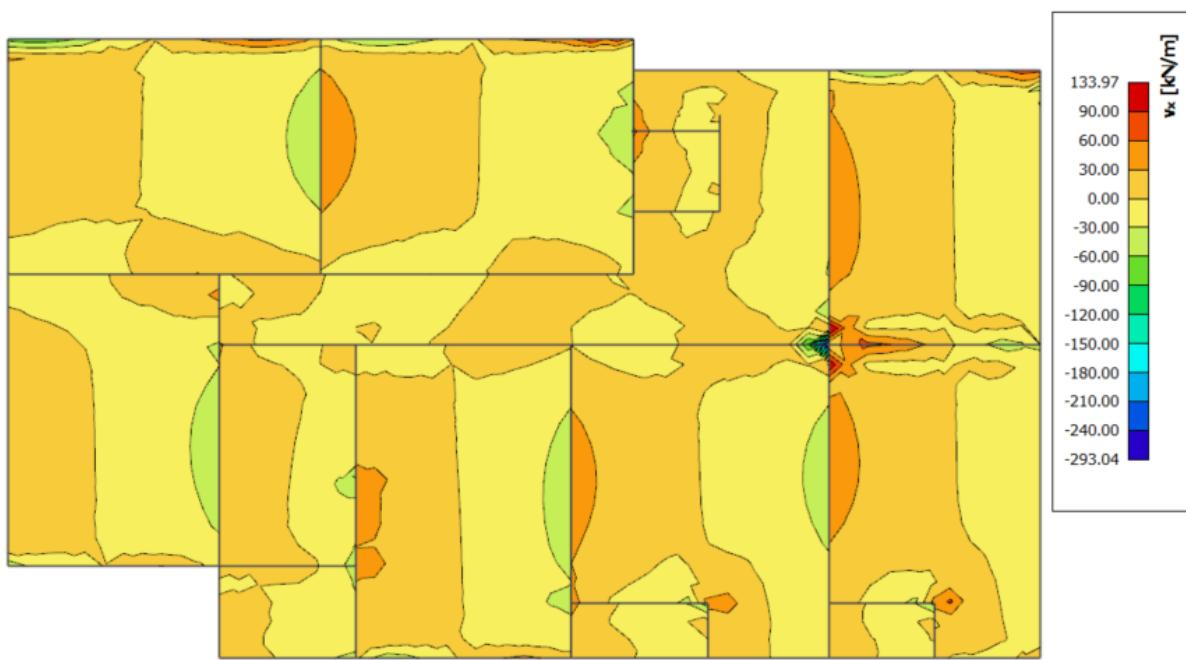
Slika 5.5. Poprečne sile  $V_{Ed,x}$  (kN/m) za GSN
