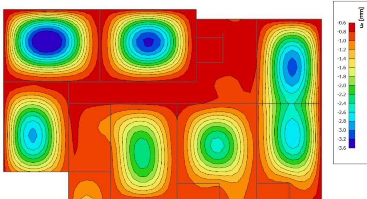
Slika 5.11. Progib ploče (mm) za kombinaciju GSU2
