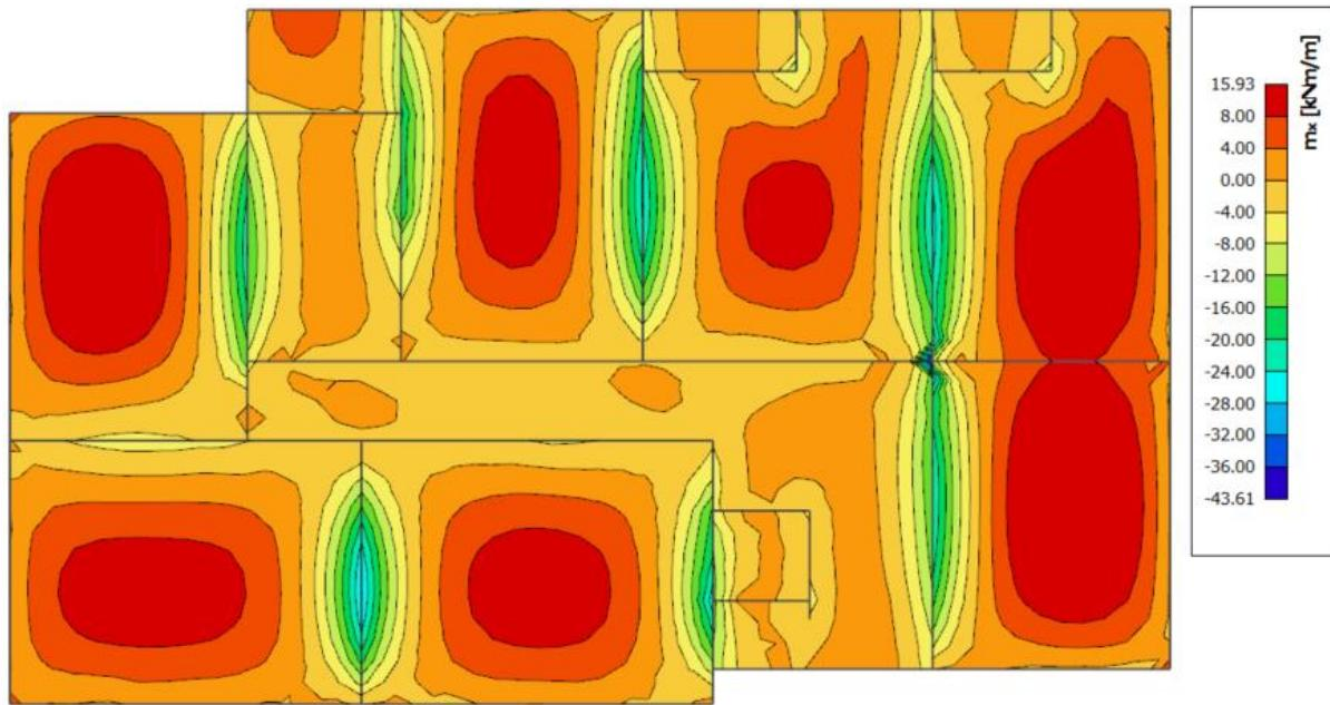
Slika 5.12. Moment savijanja  $M_{Ed,x}$  (kNm/m) za GSU1
