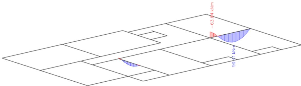
Slika 7.3. Moment savijanja  $M_{Ed,y}$  (kNm) za GSN
