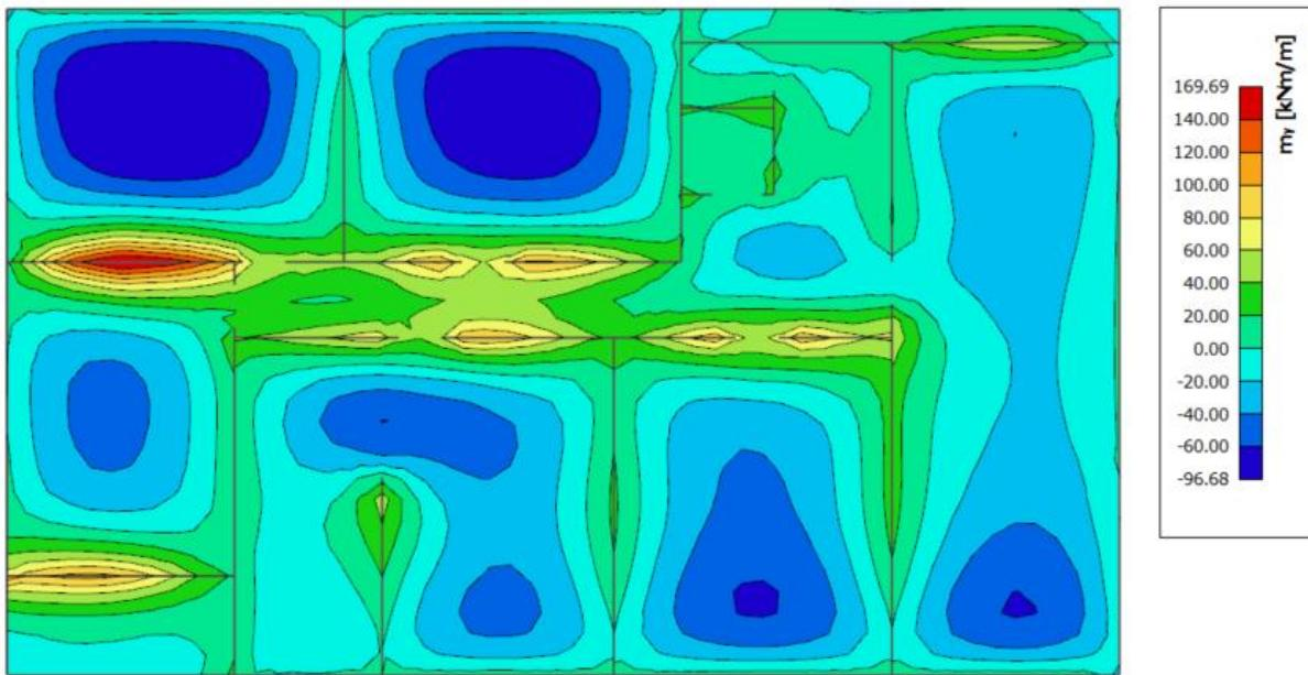
Slika 9.11. Moment savijanja  $M_{Ed,y}$  (kNm) za GSU1
