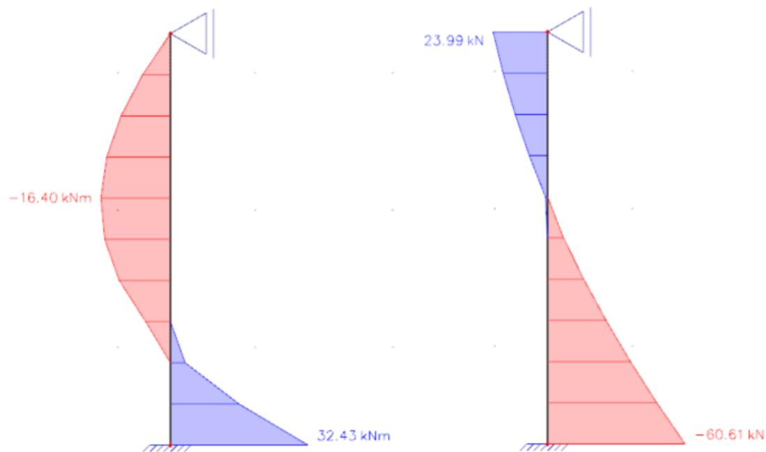
Slika 12.3. Prikaz momenta savijanja  $M_{Ed,y}$  (kNm/m) i poprečne sile  $V_{Ed,x}$  (kN/m) za kombinaciju K2
