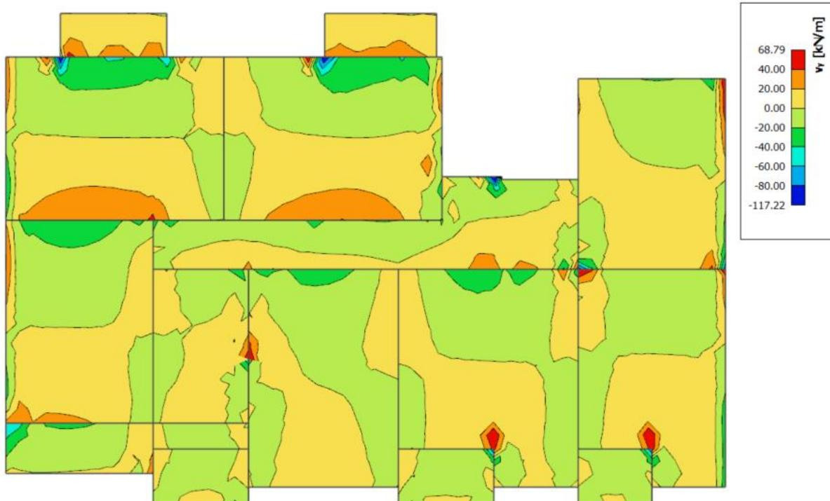
Slika 4.6. Poprečne sile  $V_{Ed,y}$  (kN/m) za GSN
