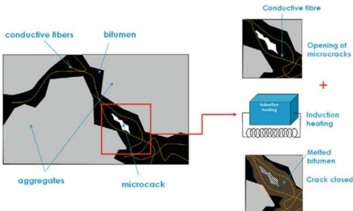
*Slika 29. Shematski prikaz sistema korištenja vlakana s induciranim energijom za zatvaranje pukotina u asfalt betonu [3]*
