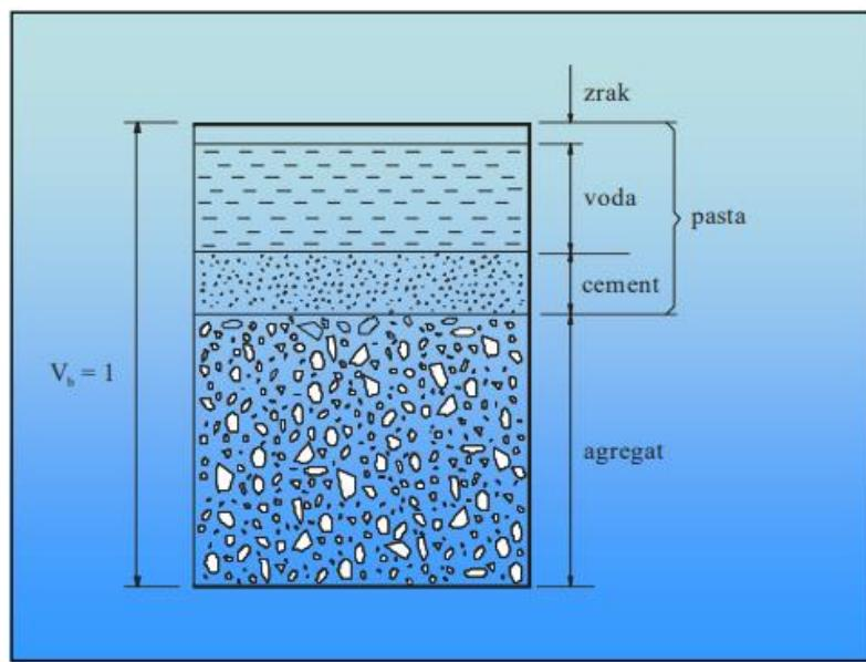
*Slika 5. Volumni udio pojedinih sastojaka u ukupnom volumenu betona [12]*
