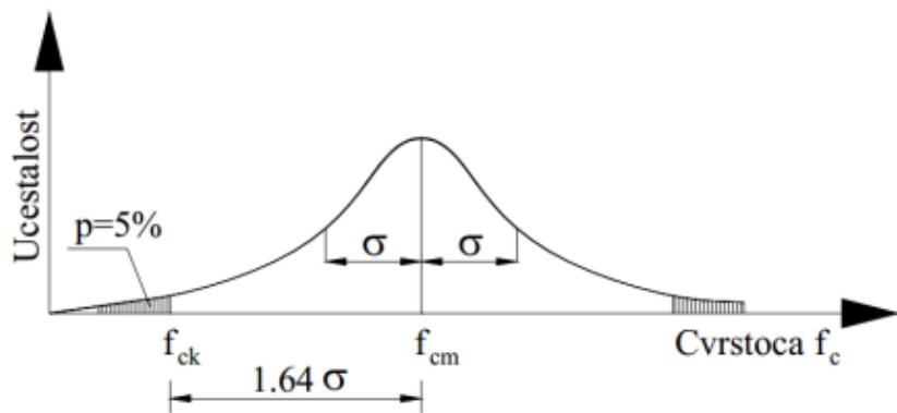
Slika 7. Gaussova krivulja raspodjele ispitivanja vrijednosti tlačne čvrstoće [1]
