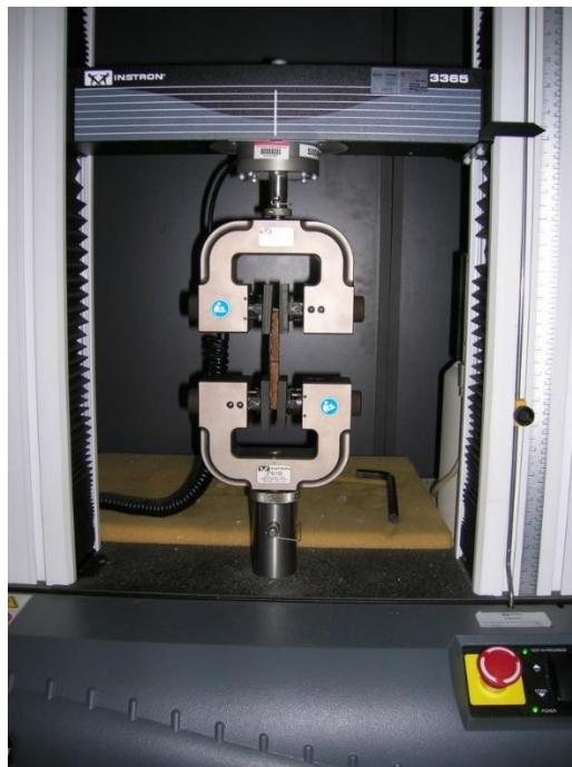
*Slika 32. Uređaj za ispitivanje vlačne čvrstoće [62]*
