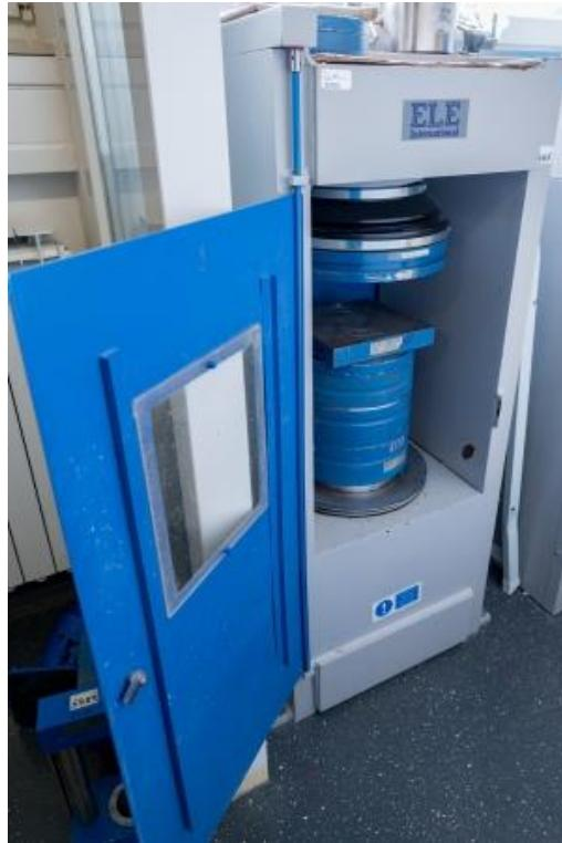
Slika 6. Tlačna preša [99]
