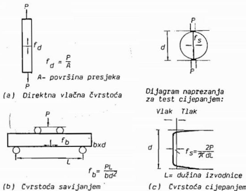
Slika 8. Sheme testiranja vlačne čvrstoće [14]
