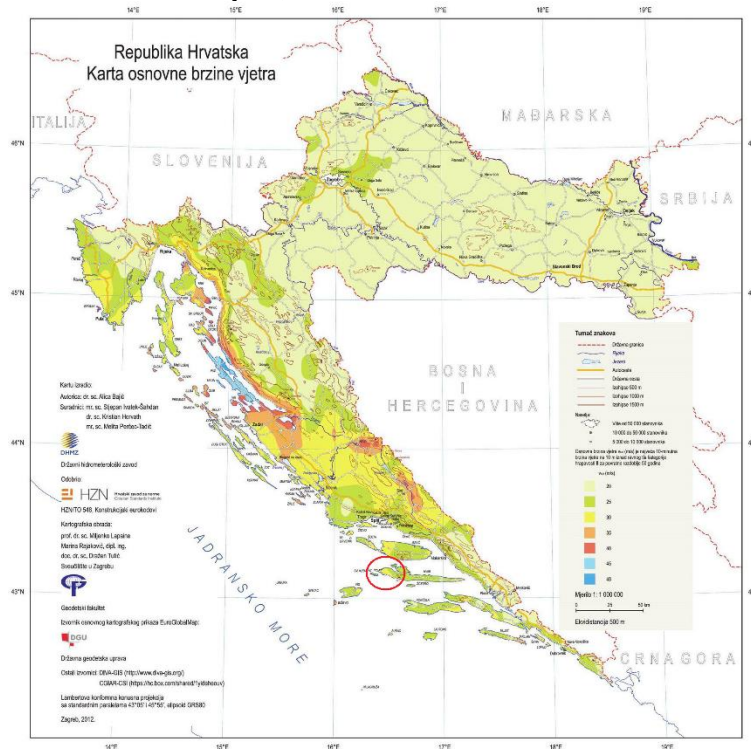
Slika 16 Karta osnovnih brzina vjetra V_{b,0}
