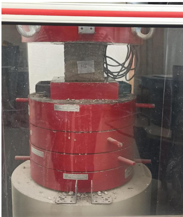
Slika 45 Primjer ispitivanja tlačne čvrstoće
