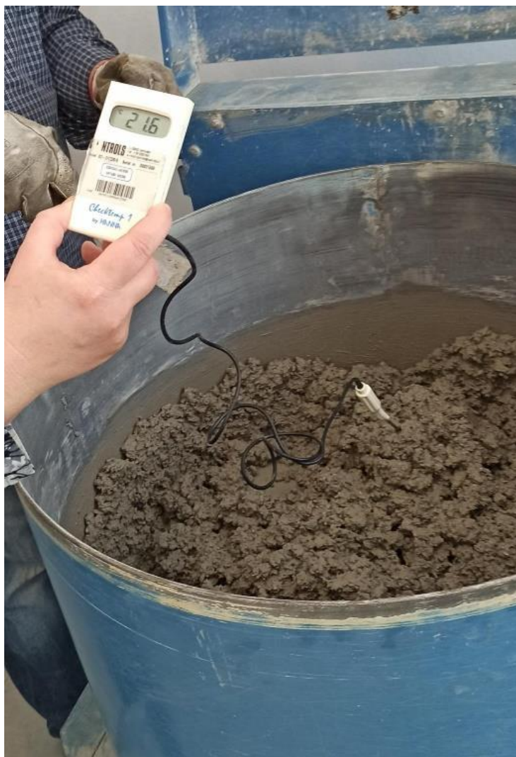
Slika 42 Temperatura uzorka E
