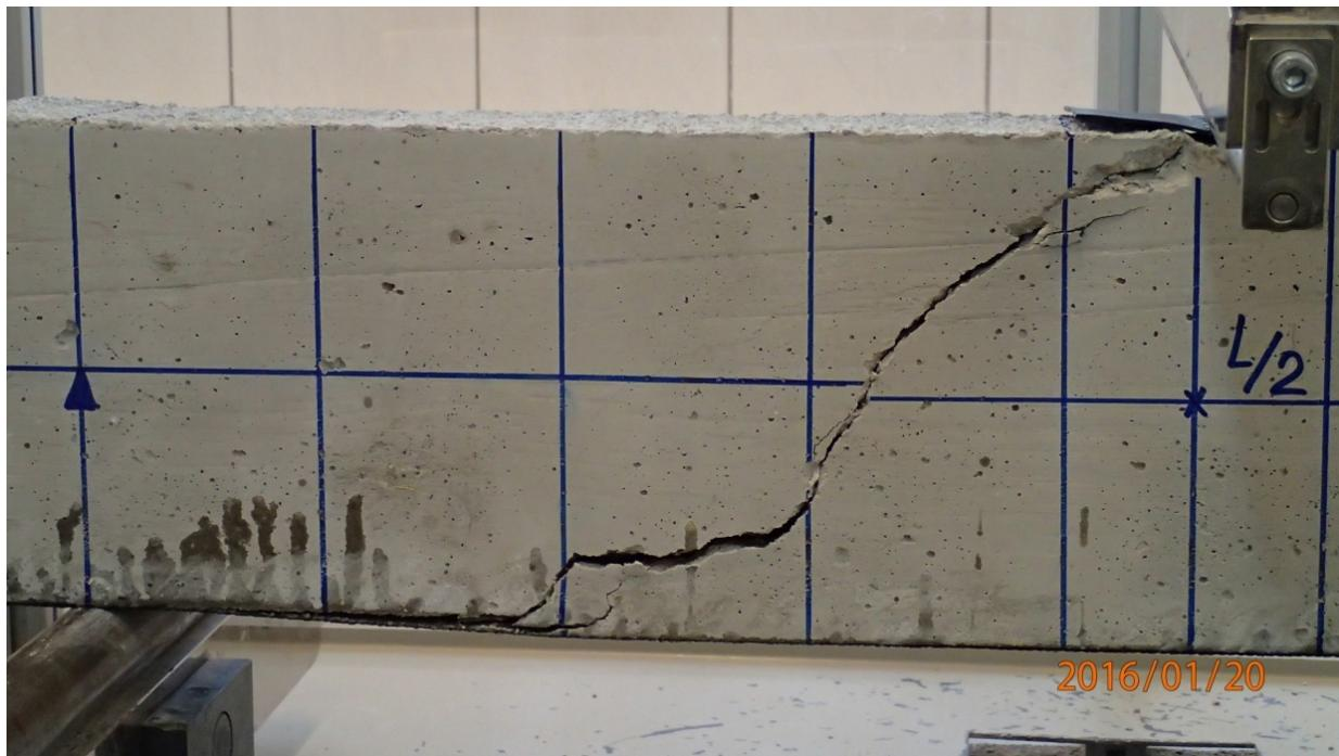
**Fotografija 4.13:** Slom grede G2 (ojačana karbonskom trakom)
