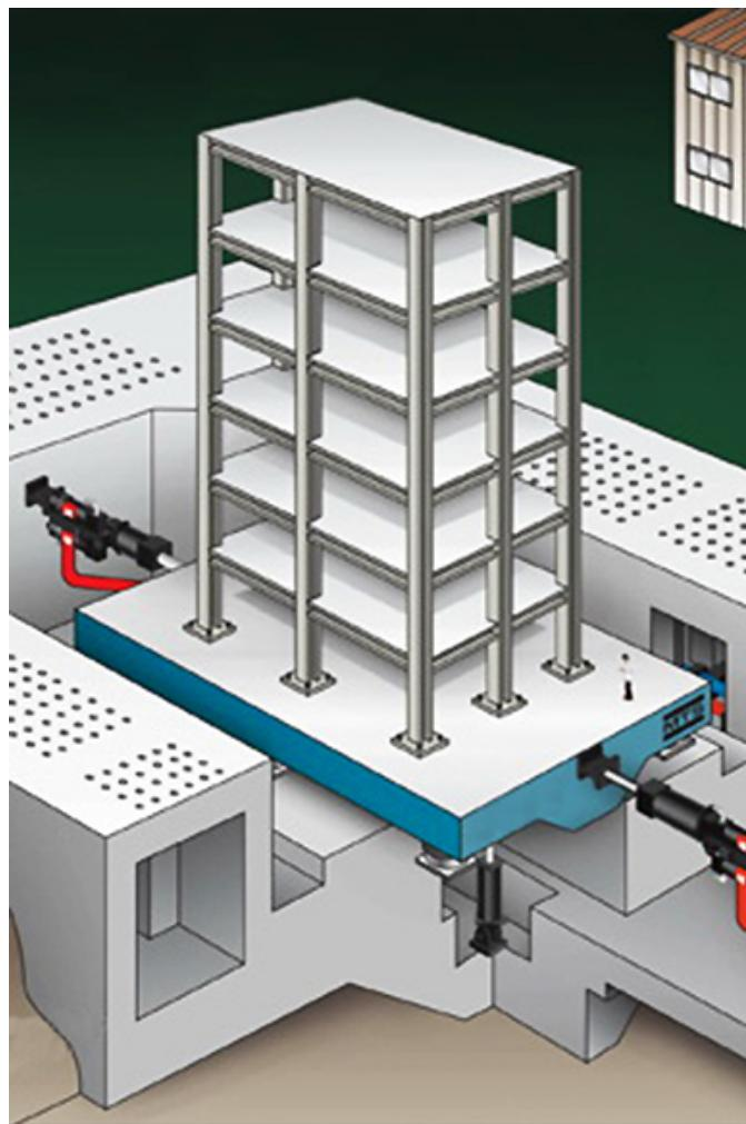
**Crtež 1.1:** Dinamičko ispitivanje konstrukcije na potresnoj platformi
