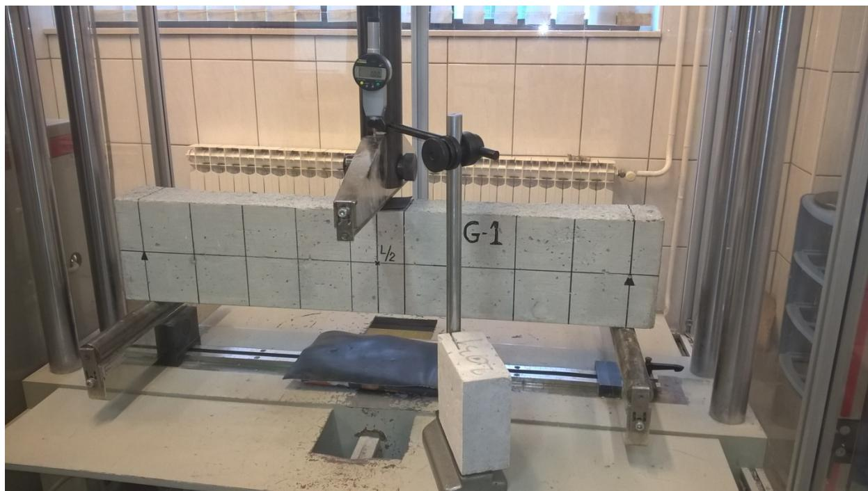
**Fotografija 4.7:** Početak ispitivanja grede G1
