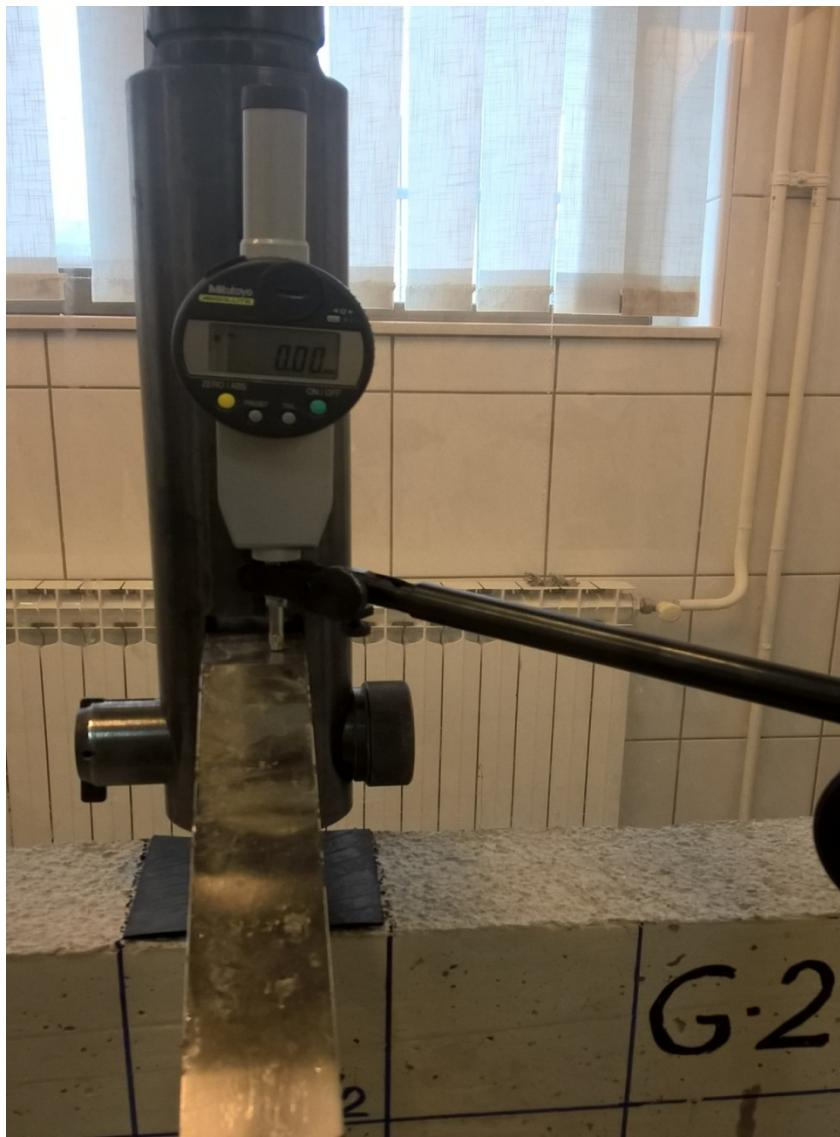
**Fotografija 4.6:** Slika postavljanja i nuliranja mikroure
