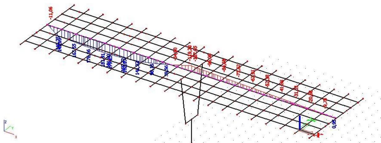
Slika 28 : Pokretno – max. poprečne sile pri upornjaku – momenti (  $M_y$  ) u kNm
