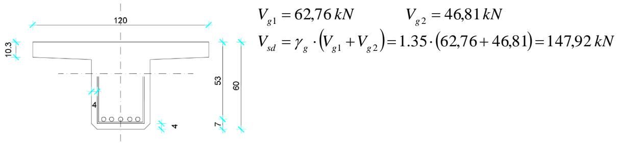
Dio poprečne sile koju preuzima beton i uzdužna armatura:
