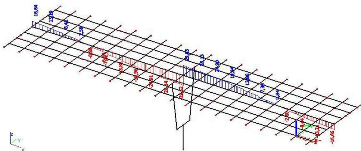
Slika 12: Dodatno stalno - poprečne sile ( $V_z$ ) u kN
