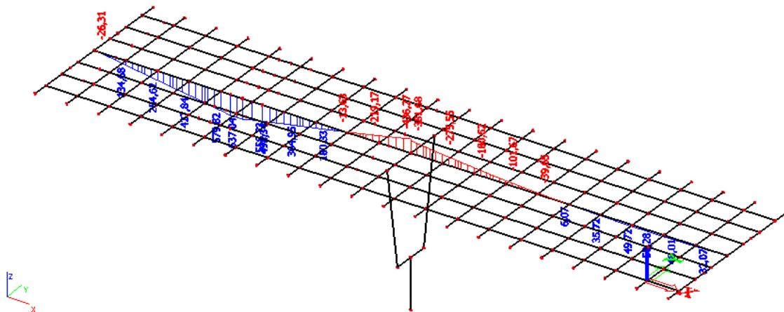
Slika 20 : Pokretno – max. momenti pri stupu - momenti (  $M_y$  ) u kNm
