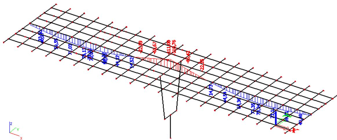
Slika 11: Dodatno stalno - momenti ( $M_y$ ) u kNm
