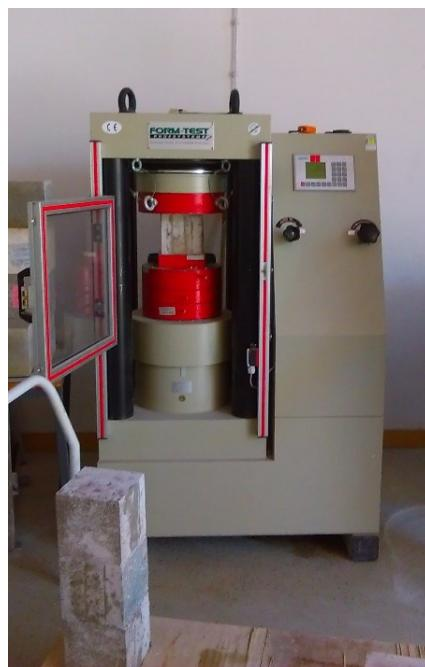
Slika 4.18. Laboratorijska preša za određivanje tlačne čvrstoće betonskih uzoraka
