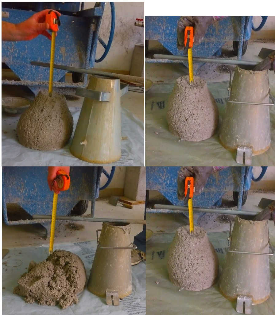
Slika 4.7. Slijeganja uzoraka betona [slika zabilježena tijekom ispitivanja]
