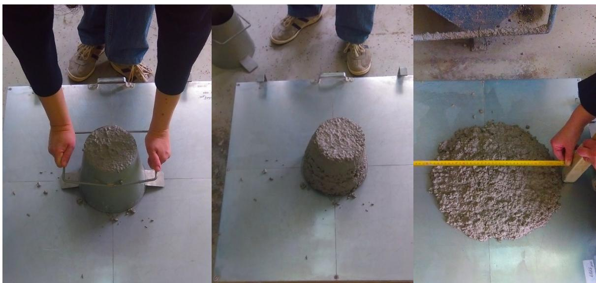
Slika 4.13. Metoda rasprostiranja [slika zabilježena tijekom ispitivanja]
