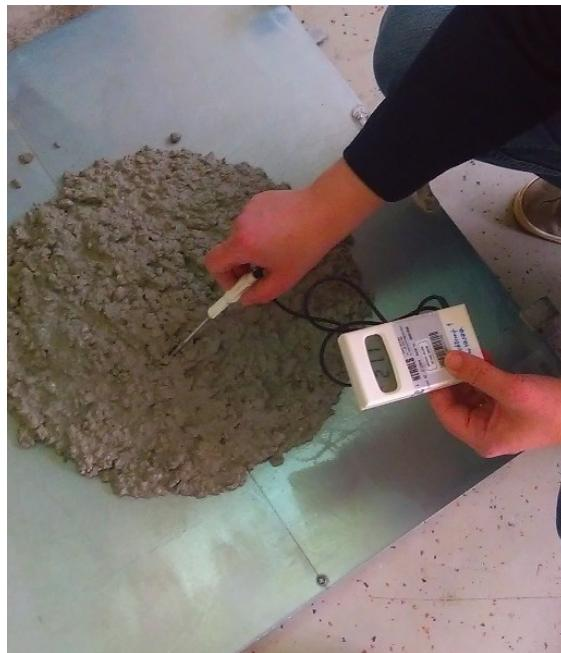
Slika 4.16. Mjerenje temperature[slika zabilježena tijekom ispitivanja]
