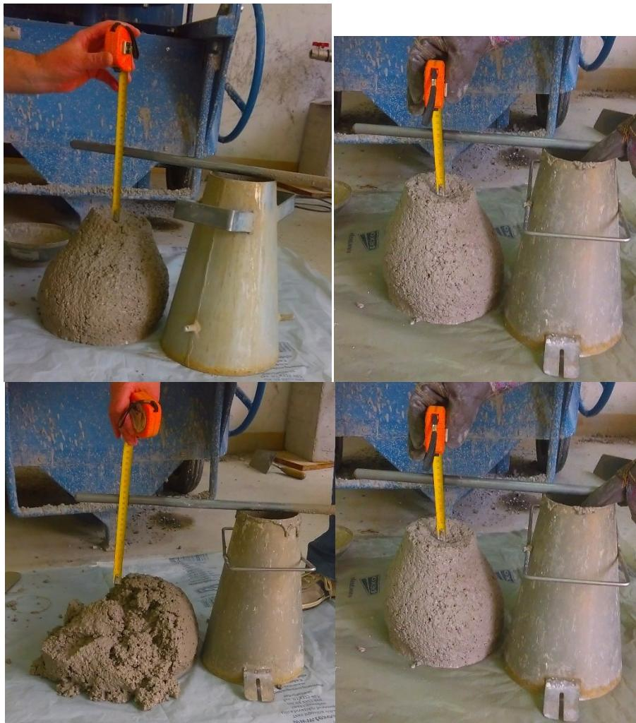
Slika 4.7. Slijeganja uzoraka betona [slika zabilježena tijekom ispitivanja]
