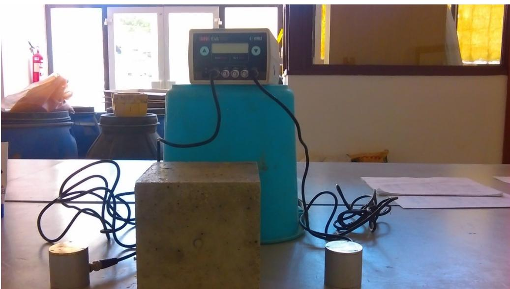
Slika 4.20. Ispitivanje ultrazvukom [slika zabilježena tijekom ispitivanja]
