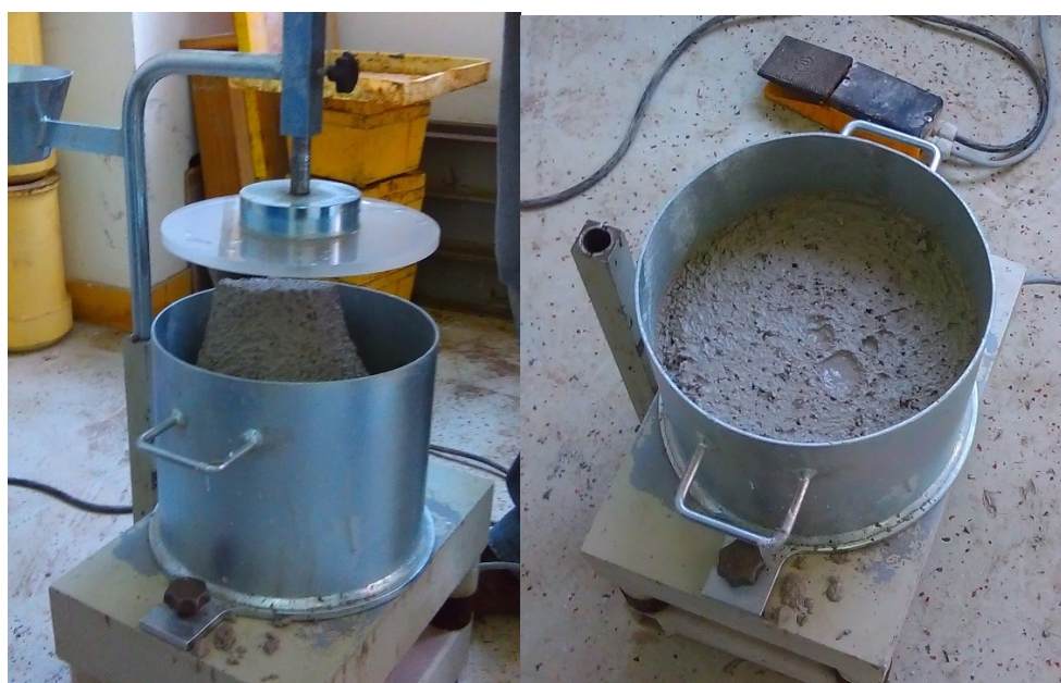
Slika 4.9. Metoda pomoću Vebe aparata [slika zabilježena tijekom ispitivanja]
