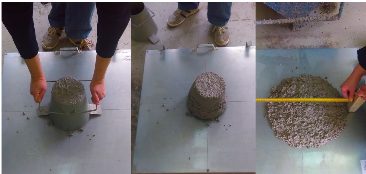
Slika 4.13. Metoda rasprostiranja [slika zabilježena tijekom ispitivanja]
