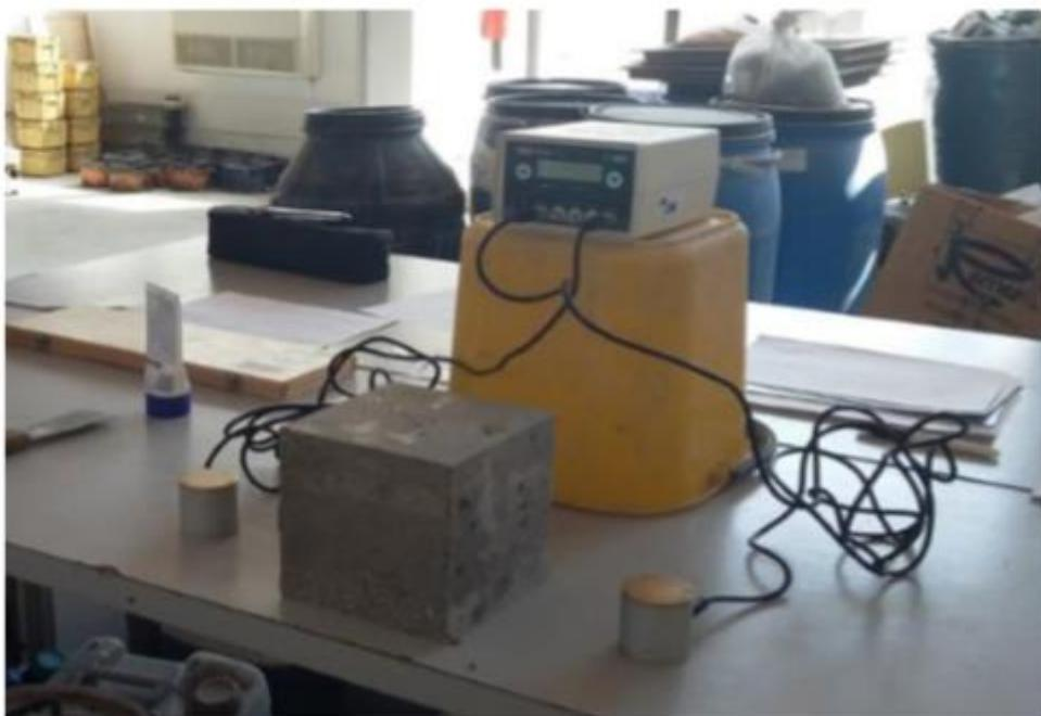
Slika 27. Ispitivanje ultrazvukom [slika zabilježena tijekom ispitivanja]
