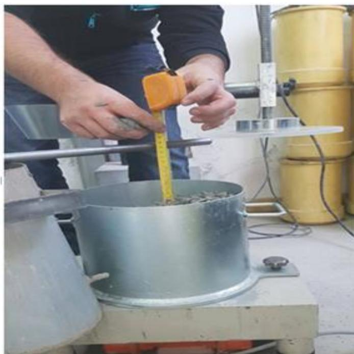
Slika 21. Mjerenje konzistencije Vebe metodom
