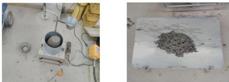
Slika 18. Rasprostiranje betona s dodatkom letećeg pepela [slike zabilježene tijekom ispitivanja]
